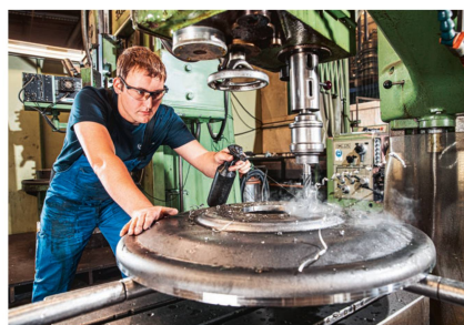
La plus grande précision est requise. On voit, sur la photo de droite, le tournage des trous de moyeu et des cercles primitifs du disque de roue sur le tour vertical à carrousel.
