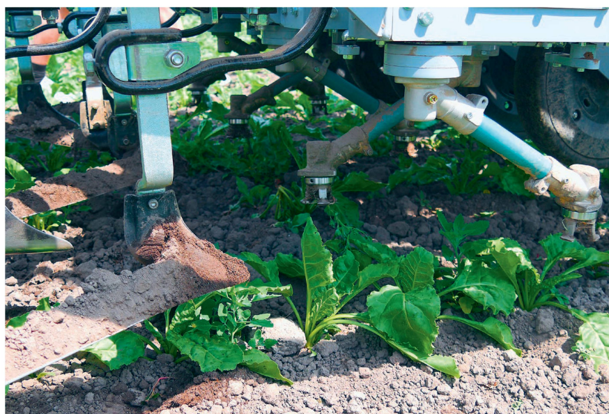
Le «Farming GT» n'assure que le binage. Il travaille avec une tête fraiseuse rotative entre les plantes et un soc unilatéral entre les rangées.
