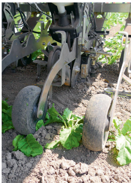
Le «FarmDroid» peut effectuer le semis et le binage.
