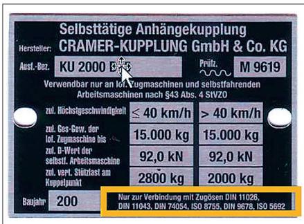
Ces plaquettes donnent des informations sur les types d'œillets qui peuvent être utilisés pour l'attelage.
