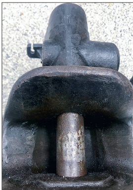
Différentes conceptions de plaques ressort sont utilisées dans les chapes d'attelage.
