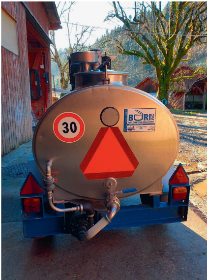
Pour les vitesses inférieures ou égales à 30 km/h, un macaron indiquant la vitesse maximale et un triangle véhicules lents doivent être apposés. Photo: Buri AG, Hasle-Rüegsau
