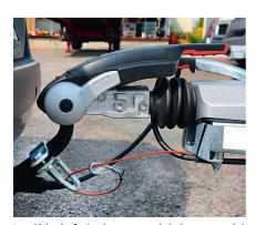
Le câble du frein de secours doit être accroché à un œillet au moyen du mousqueton au véhicule tracteur ou à l'attelage de remorque.
