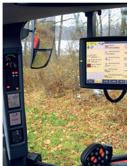
Sur le Steyr, le terminal Isobus n'est pas monté sur l'accoudoir, mais sur l'arceau de maintien de la porte droite de la cabine.
