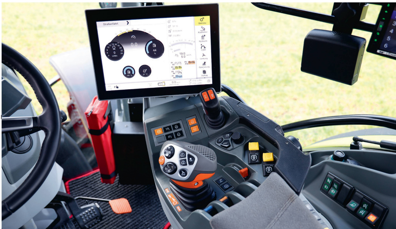
Commande «Cebis»: le levier multifonction ergonomique offre de nombreuses possibilités, ainsi qu'une bonne prise en main.
