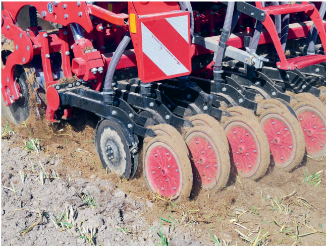
Les socs à doubles disques «TurboDisc» à suspension en caoutchouc se distinguent par leur fonctionnement tout en douceur.
