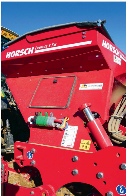
La profondeur de semis se règle hydrauliquement. En cas de besoin, elle peut être fixée par des cales sur les vérins.
