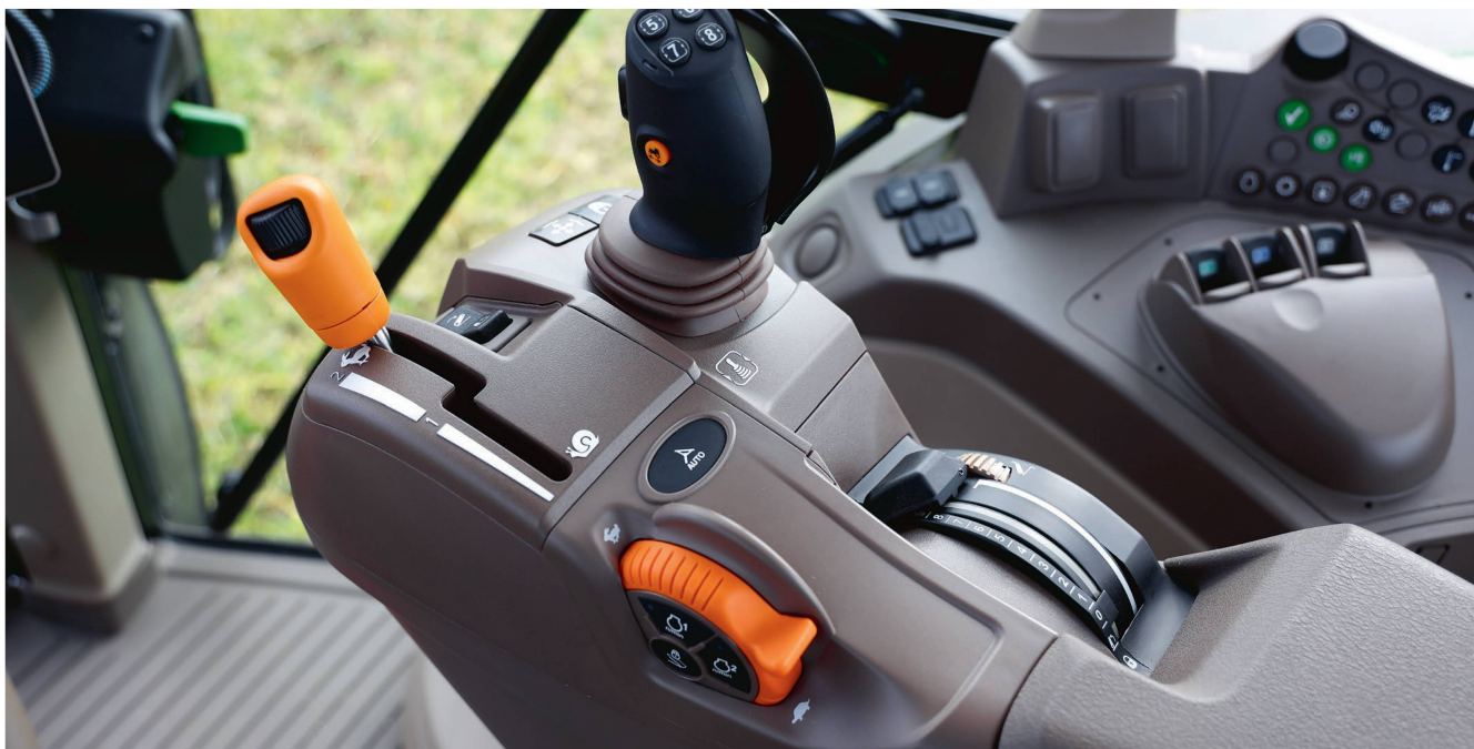
L'accoudoir compact du John Deere «6120 M AutoPowr» inclut un levier de commande de transmission et de relevage, un joystick électronique ainsi qu'un accélérateur à main.
