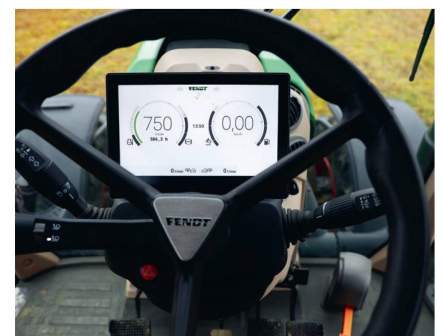
Ce tableau de bord numérique peut, comme les deux autres terminaux, se configurer librement avec différentes fonctions d'affichage.
