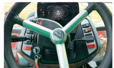
Le terminal numérique à écran tactile sert à la fois de tableau et d'ordinateur de bord.
