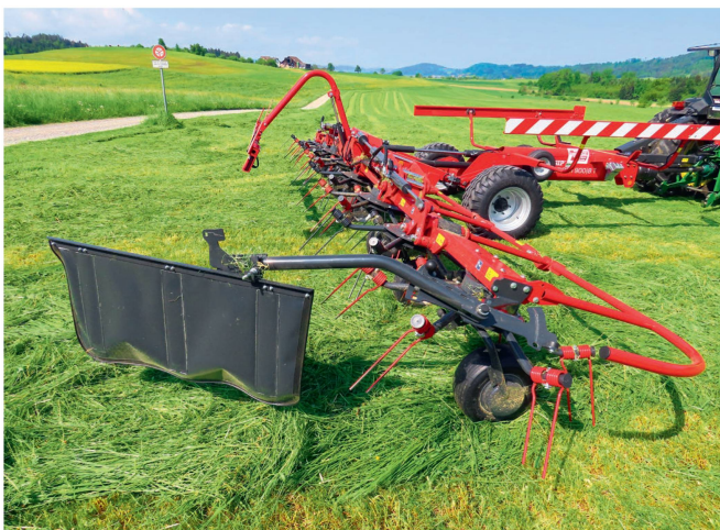
Le déflecteur de bordure optionnel doit être déplié manuellement. Un repliage hydraulique est livré en option.
