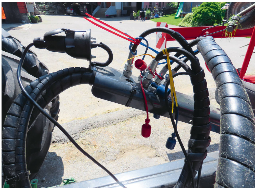
La faneuse est dotée d'un rangement exemplaire pour les flexibles. Il manque seulement le repérage de ces derniers et le support du connecteur d'éclairage.
