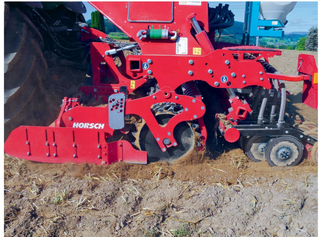
Lourd et massif, le rouleau packer de 64 cm de diamètre à dents aide à niveler et rappuyer le lit de semence.
