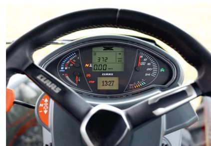
Le tableau de bord classique pivote selon le réglage de l'inclinaison du volant.
