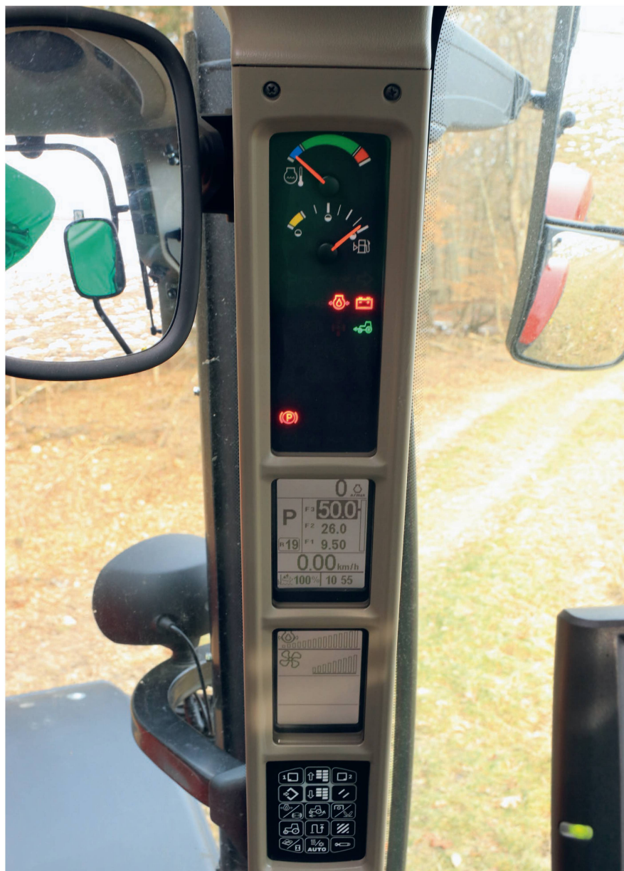
L'écran enchâssé dans le montant avant droit comporte les fonctions principales du tracteur et un moniteur de performances.
