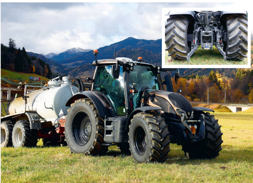
Le Valtra «N135 direct» possède de loin le système hydraulique le plus puissant et le relevage arrière avec la capacité la plus élevée du test. La version de ce tracteur à variation continue intègre un moteur plus puissant que celle à boîte à rapports enclenchables sous charge.
