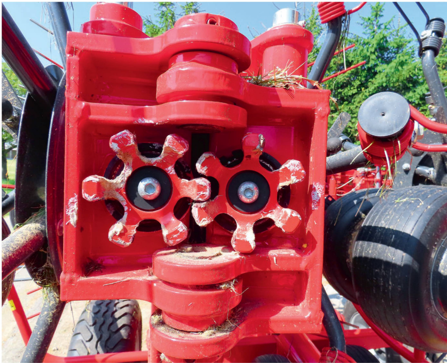
Le crabotage exempt d'entretien assure un fonctionnement sans à-coups.
