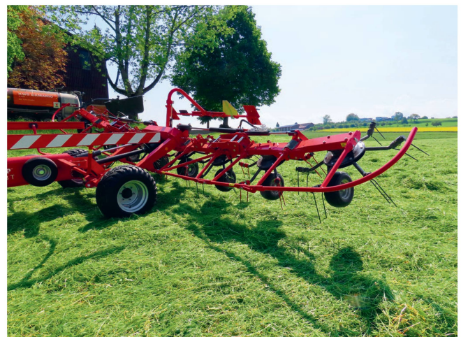
Lors du relevage en fourrière, les toupies extérieures contribuent à soulever les toupies intérieures.
