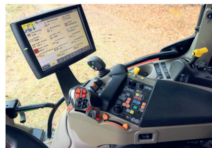
Les commandes de l'accoudoir intègrent le «Multicontroller», le joystick et le terminal tactile.
