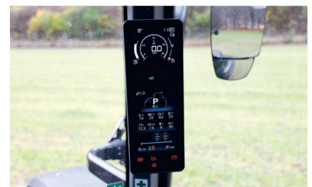
Valtra a remplacé le tableau de bord par un écran sur le montant avant droit. Celui-ci est lumineux, coloré et très lisible.
