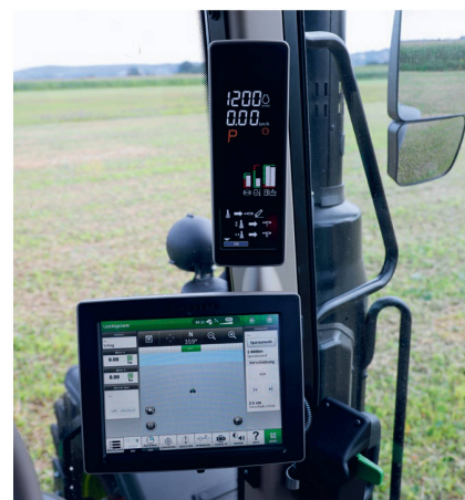
L'écran tactile «4240» installé en option sur le montant avant droit affiche des fonctions de conduite et la commande des outils.
