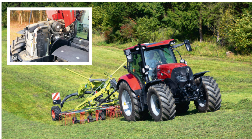
La cabine du Case IH «Maxxum 135 CVX Drive» n'est pas du dernier cri mais c'est la plus silencieuse de notre essai, avec un niveau sonore de 65,9 dB(A). Ce tracteur possède le moteur le plus puissant des sept candidats, et il fait preuve de sobriété.
