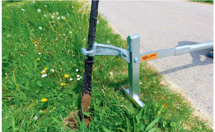
Pour extraire les piquets, on a besoin de cet extracteur, ou d'un outil similaire spécifiquement conçu à cet effet.
