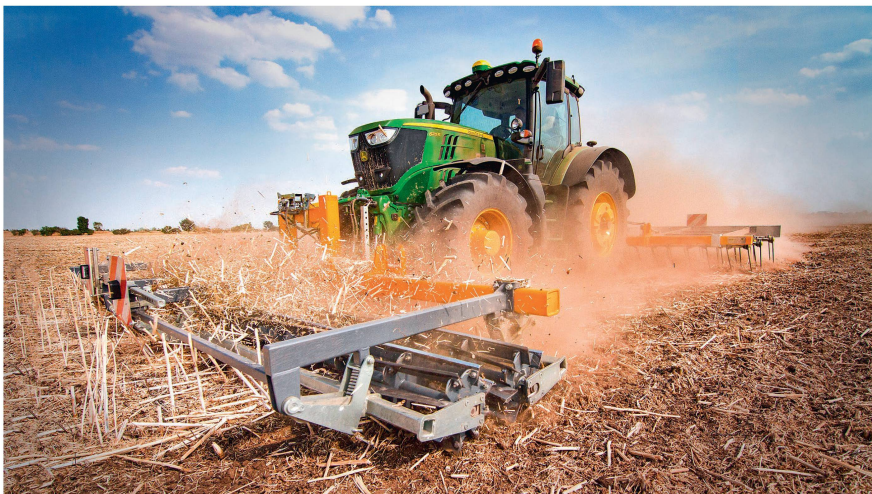
Cette architecture dissociée intègre un rouleau couteau à l'avant et une herse à éteules à l'arrière. Photo: Wallner Maschinenbau
