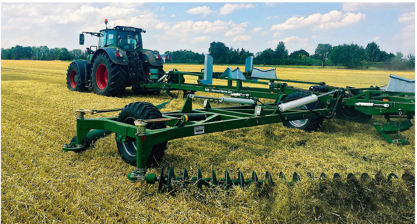
Jamais trop profond: les déchaumeurs à chaîne de disques conviennent bien pour un déchaumage à la fois superficiel et efficace. Photo: Eilbote
