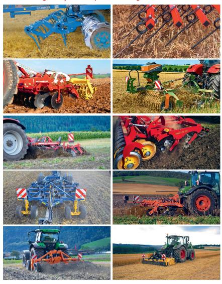
12,5 kW à 24 kW est nécessaire par mètre de largeur de travail. Le poids de l'appareil dépend également du type de disque. Il se situe par exemple entre 120 et 148 kg/m de largeur de travail chez Fliegl alors qu'il
