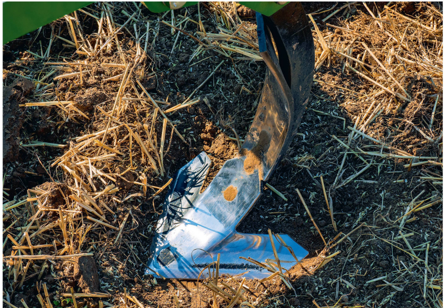
Les socs en patte d'oie se déclinent aussi en variantes très résistantes à l'usure. Photo: Amazone
