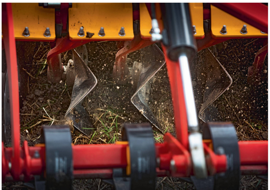
De nouveaux composants tels les disques gaufrés assurent un mélange intensif. Photo: Väderstad
