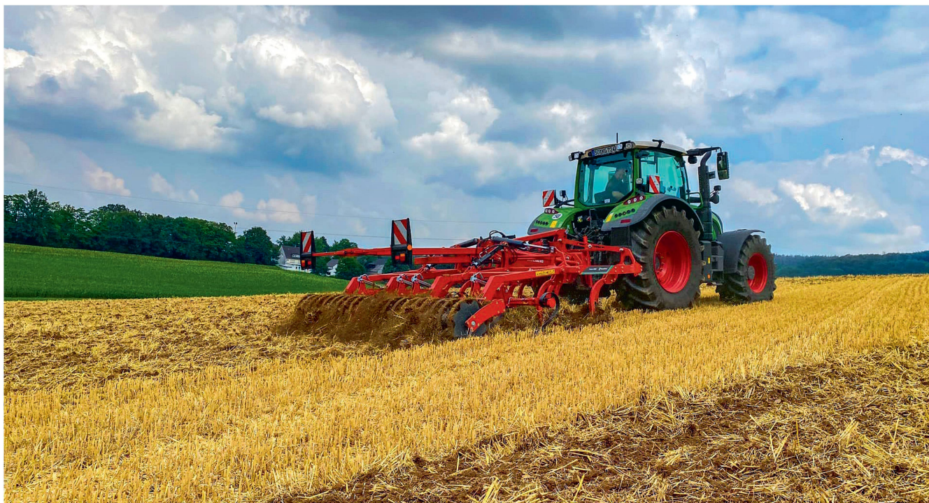
Pour qu'un cultivateur travaille bien, il est recommandé de le déporter d'au moins dix degrés par rapport à l'angle du semis. Photo: Kverneland
