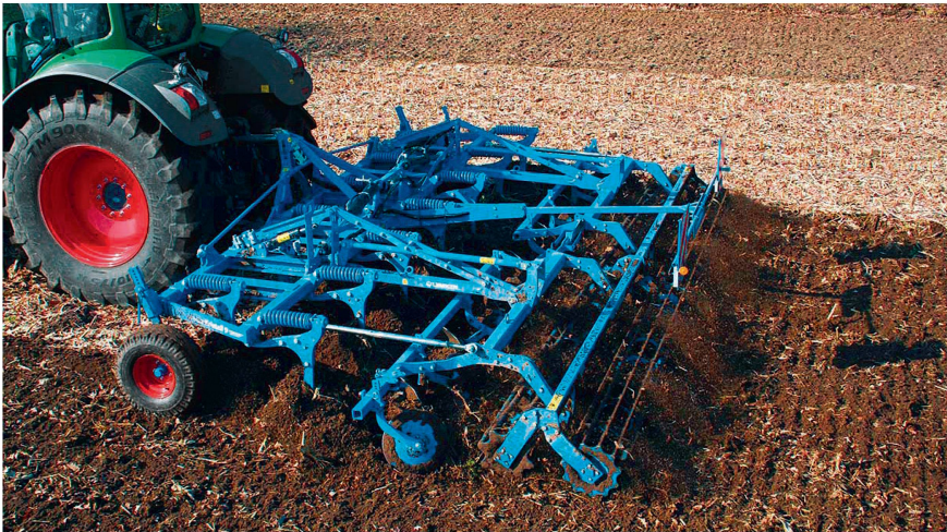
Les outils de nivellement et de bordure appropriés laissent une surface plane sans buttes ni sillons. Photo: Lemken
