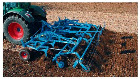
Les outils de nivellement et de bordure appropriés laissent une surface plane sans buttes ni sillons. Photo: Lemken
