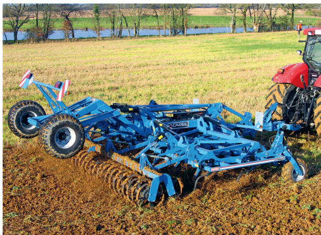
Plus l'écartement est réduit, plus le travail est superficiel. C'est le cas avec un cultivateur léger ou un vibroculteur. Photo: Carré
