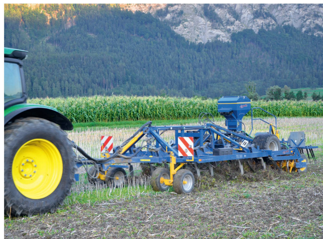
Un outil tracté avec châssis à l'avant et rouleau porteur effectue un travail en surface très homogène. Photo: Ruedi Hunger
