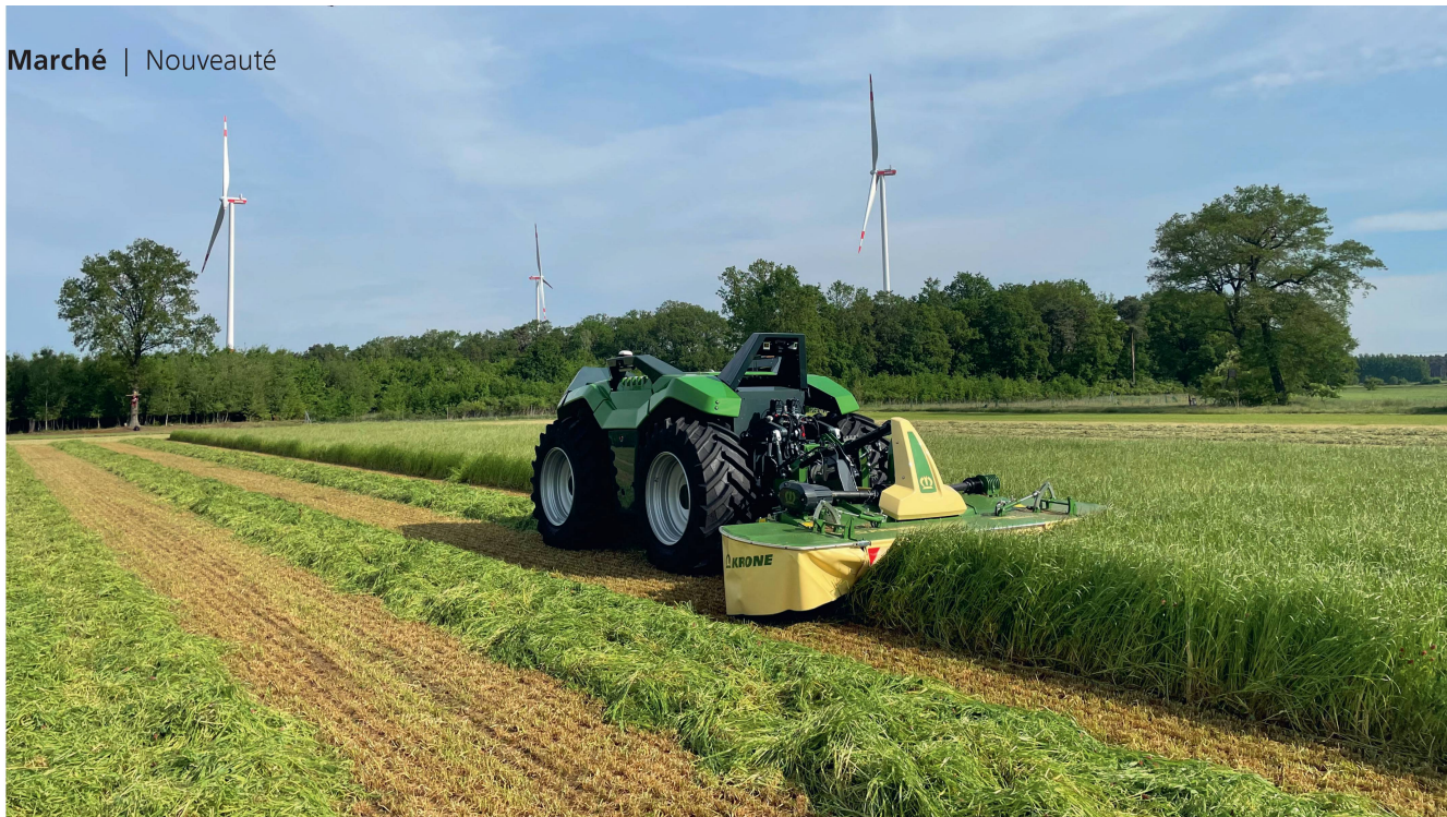
Conçu par Krone et Lemken, le porte-outils autonome VTE (ici équipé d'une faucheuse frontale) est muni d'un relevage conventionnel et se caractérise par sa polyvalence. Photos: Matthieu Schubnel
