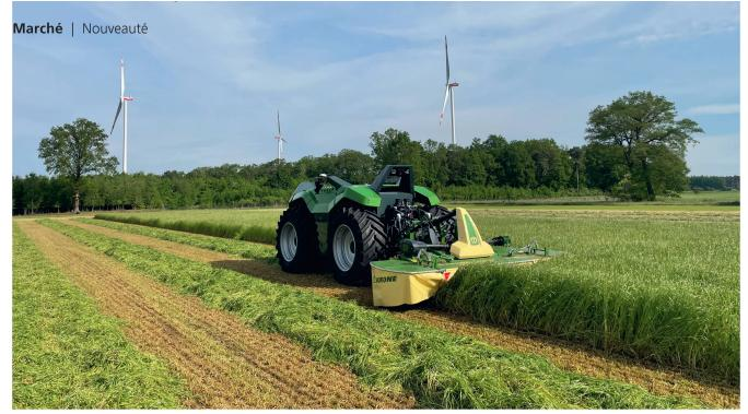
Conçu par Krone et Lemken, le porte-outils autonome VTE (ici équipé d'une faucheuse frontale) est muni d'un relevage conventionnel et se caractérise par sa polyvalence. Photos: Matthieu Schubnel
