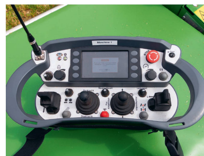
Lors des manœuvres d'attelage/déattelage ou d'une intervention non programmée, l'opérateur pilote l'automoteur manuellement à l'aide d'une télécommande similaire à celle d'une grue.
