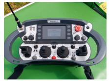
Lors des manœuvres d'attelage/dételage ou d'une intervention non programmée, l'opérateur pilote l'automoteur manuellement à l'aide d'une télécommande similaire à celle d'une grue.
