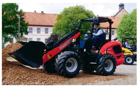
Modèle de plus grande capacité de cette nouvelle gamme, la «MLA 5-50 H» soulève 1880 kg au godet et porte les charges à la hauteur de  $3,07~\mathrm{m}$ .
