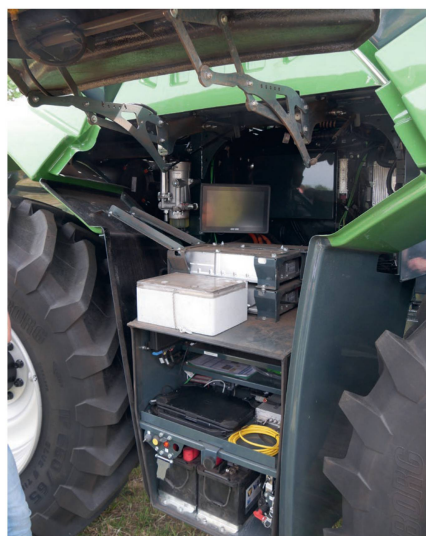
Sur cette machine embarquant une vingtaine d'ECU (unités de contrôle électronique), la plupart des logiciels ont été développés par Lemken et Krone.
