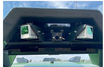
L'avant et l'arrière de l'appareil logent chacun une caméra stéréo, deux lidars ainsi qu'une caméra conventionnelle.
