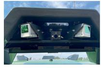
L'avant et l'arrière de l'appareil logent chacun une caméra stéréo, deux lidars ainsi qu'une caméra conventionnelle.
