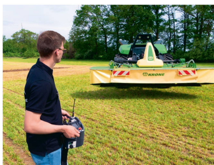
Lors des manœuvres d'attelage/déattelage ou d'une intervention non programmée, l'opérateur pilote l'automoteur manuellement à l'aide d'une télécommande similaire à celle d'une grue.
