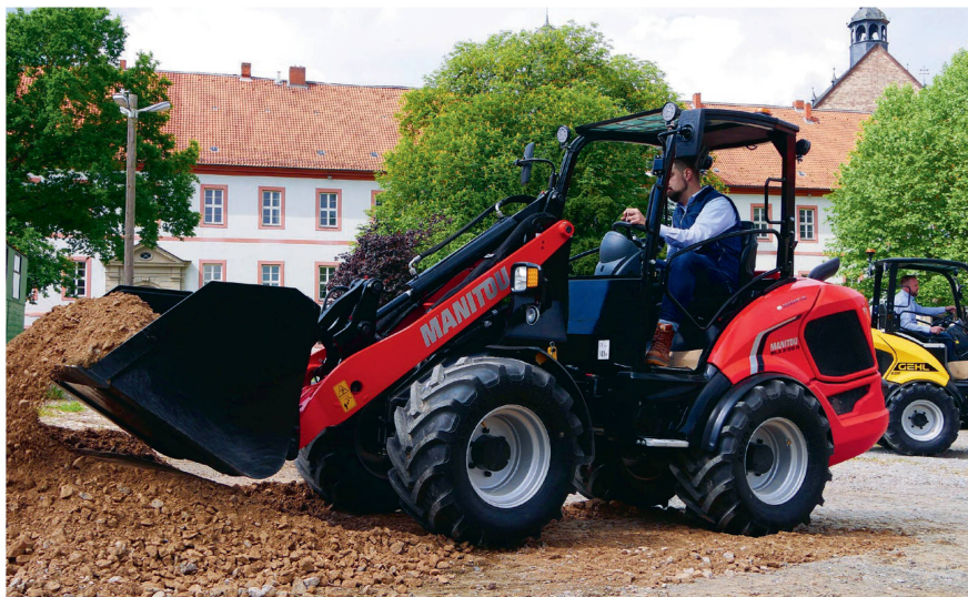
Modèle de plus grande capacité de cette nouvelle gamme, la «MLA 5-50 H» soulève 1880 kg au godet et porte les charges à la hauteur de 3,07 m.
