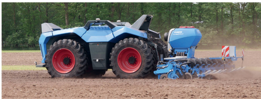
Le VTE, ici équipé d'un semoir monograine Lemken «Azurit 10» de 8 rangs, est également capable d'implanter des cultures.
