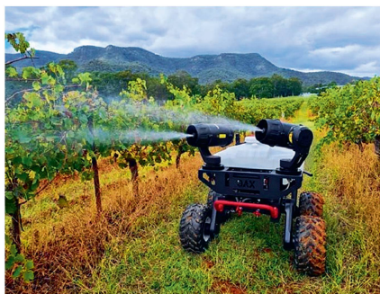
Outre son aptitude à transporter des charges, le «Rover 150» n'est au fond rien d'autre que la variante terrestre du «V40», équipé du système «JetSprayer».
