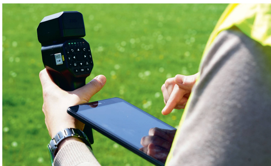
À l'aide de la tablette et du stick de contrôle, la séquence de pulvérisation complète est calculée et initiée pour une parcelle définie.
