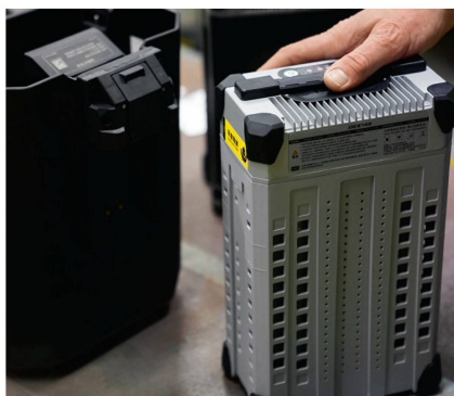
La batterie est chargée en onze minutes seulement, car elle est refroidie à l'eau (à gauche) pour empêcher tout échauffement excessif.
