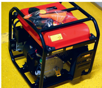
Le système de charge rapide peut être alimenté au choix par un alternateur actionné par un moteur à essence, un power bank ou le réseau public.
