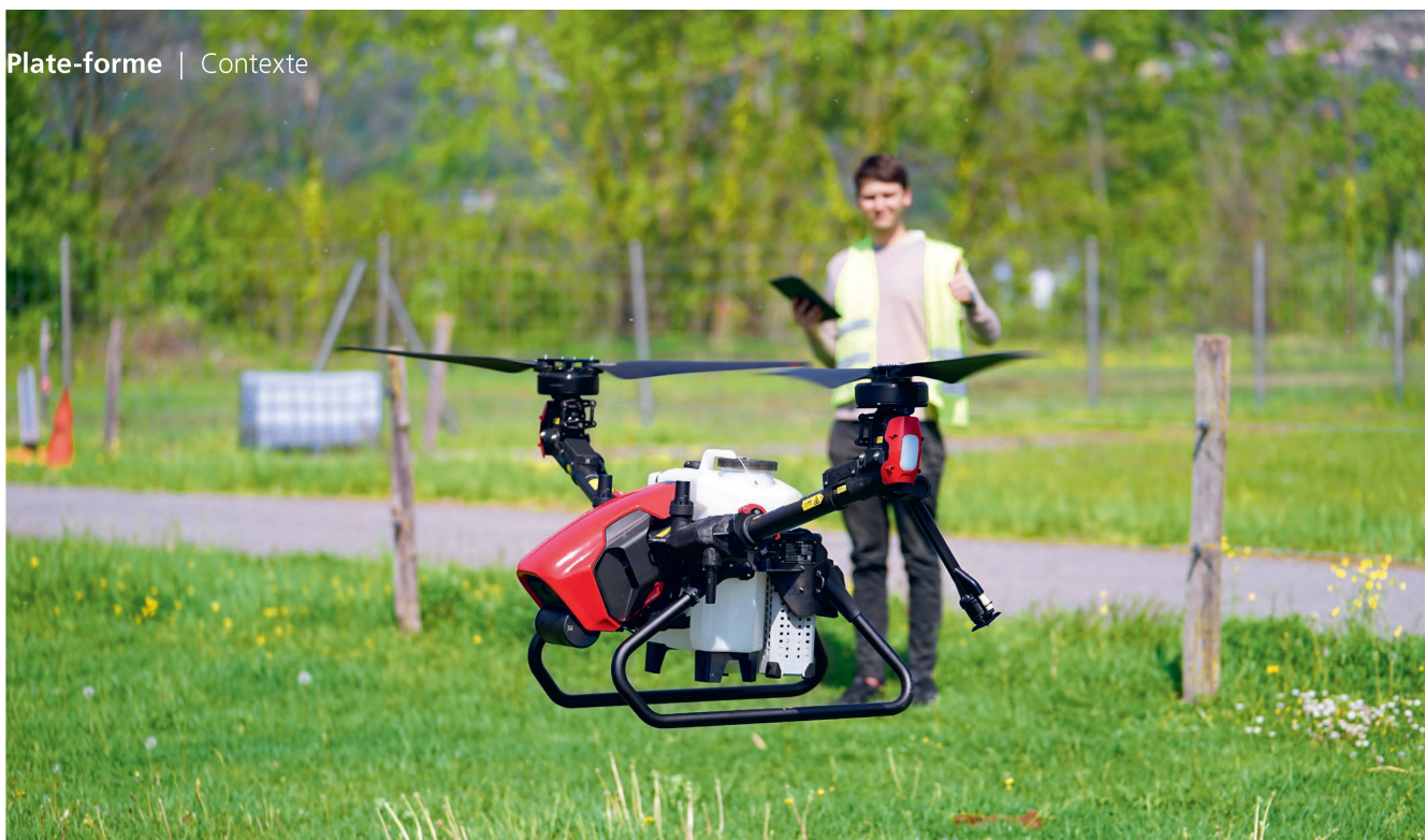
Le pilote de drone Thomas Calvi lance la séquence autonome de pulvérisation du drone agricole à double rotor «V40», muni d'un bidon de 18 litres et d'une batterie (en bas à droite). Photos: Dominik Senn et Idd
