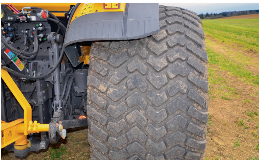
Des pneumatiques respectueux du sol figurent en tête des priorités. Ils permettent d'atteindre des pressions au sol maximales de 0,85 bar (en pleine charge) et 0,40 bar (à vide).
