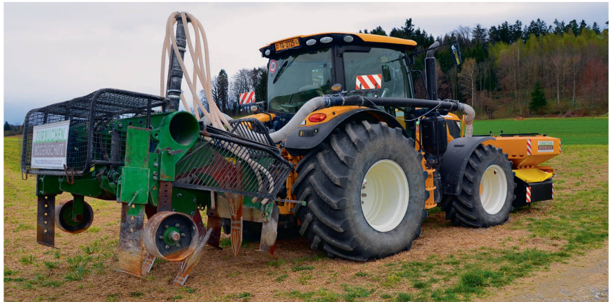
En cas de besoin, des couches du sol sont mélangées à plus d'un mètre de profondeur par des bêches rotatives qui peuvent également incorporer à la terre des matières auxiliaires liquides ou solides.
