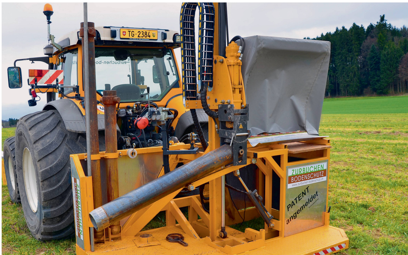
Le carottier pour profils de sol construit par Zurbuchen Bodenschutz GmbH a notamment été utilisé sur mandat de la Haute école des sciences agronomiques, forestières et alimentaires (HAFL) pour un projet de recherche dans le canton de Berne. Photos: Ruedi Hunger
