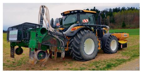
En cas de besoin, des couches du sol sont mélangées à plus d'un mètre de profondeur par des bêcheuses rotatives qui peuvent également incorporer à la terre des matières auxiliaires liquides ou solides.
