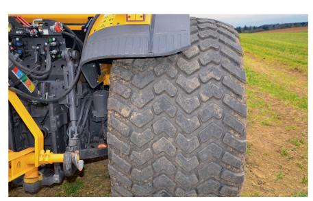
Des pneumatiques respectueux du sol figurent en tête des priorités. Ils permettent d'atteindre des pressions au sol maximales de 0,85 bar (en pleine charge) et 0,40 bar (à vide).
