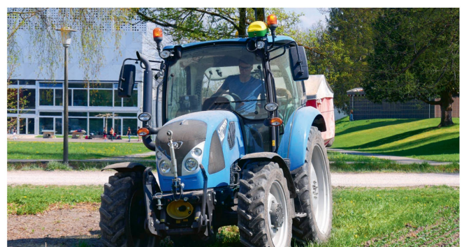
Ce tracteur Landini dispose désormais de l'intégralité des fonctionnalités Isobus et «AutoTrac».
