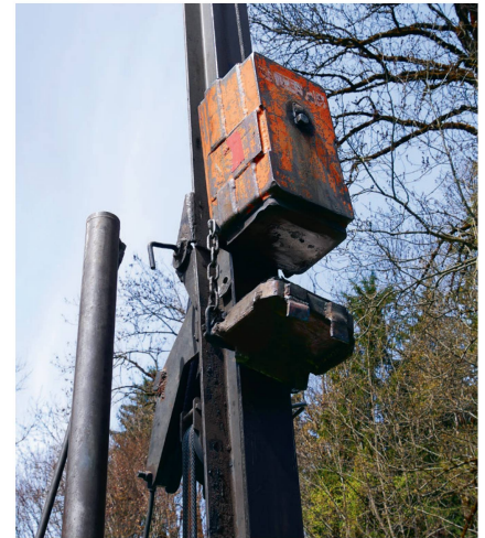
Le percuteur de 250 kg exerce une force de frappe d'une tonne par mètre de chute.
