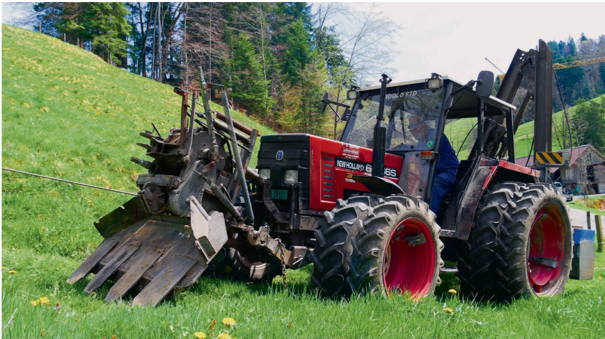
Sur les terrains en pente, Hans Blatter sécurise son attelage avec un treuil. Le tracteur tout-terrain est équipé de roues jumelées à l'avant et à l'arrière.
