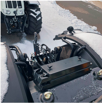
Lors du processus d'attelage, on aperçoit ici la vision du conducteur sur la boule 80 depuis son siège, dans la cabine du tracteur.
