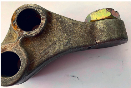
Après une collision lors de l'attelage, le levier de retenue est déformé et présente des micro-fissures. Le fabricant n'est pas responsable de ce dommage.
