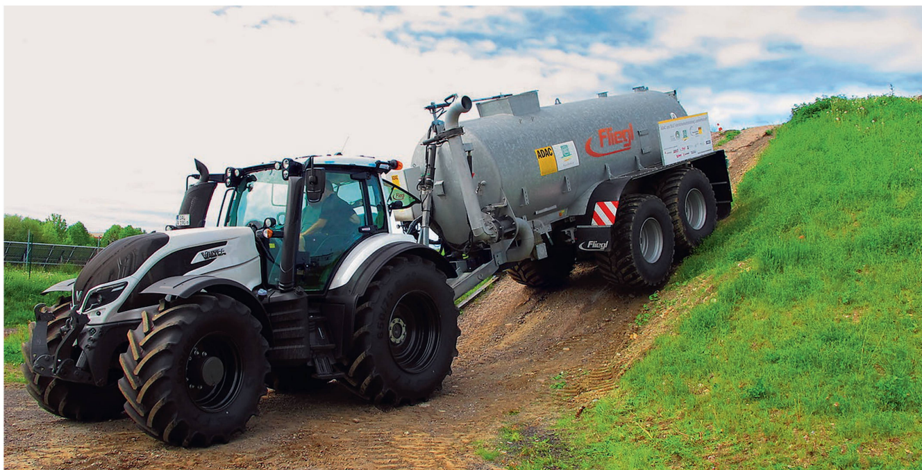
Le système d'attelage à boule Walterscheid autorise une amplitude verticale de 36 degrés lors du franchissement de talus. Photos: Walterscheid
