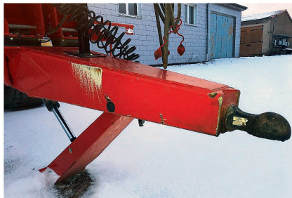
Traces évidentes de collisions entre les pneus et le timon. La plaque de tête du timon est endommagée après un choc avec la tête d'attelage.
