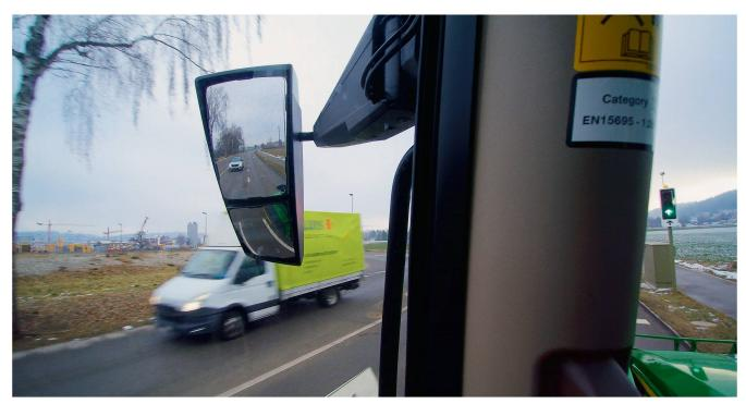
Les véhicules à moteur transportant des charges ou tractant des remorques gênant la vue doivent être équipés de chaque côté de rétroviseurs extérieurs offrant au conducteur une visibilité d'au moins 100 mètres vers l'arrière. Photo: Roman Engeler
