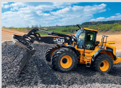
Vaisseau amiral de l'offre d'agrochargeuses du constructeur britannique, la JCB «457S» soulève plus de six tonnes et peut lever à une hauteur de 4,3 m (4,8 m en version «High Lift»).
