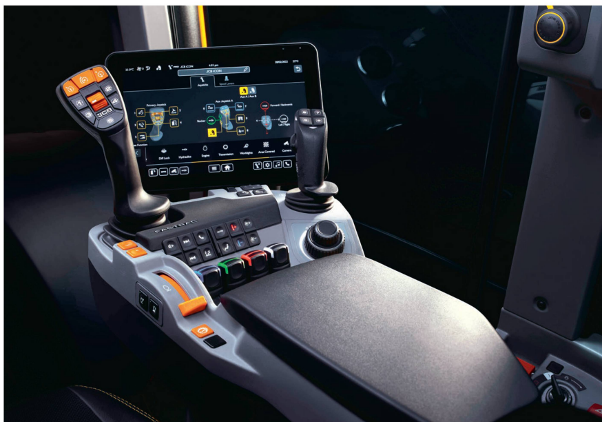
De nombreuses commandes, telles que les boutons des joysticks, sont personnalisables sur la console tactile de 12 pouces. Photo: JCB
