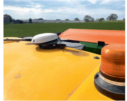
JCB fournit désormais une solution intégrée de guidage comprenant récepteur Novatel, contrôle de direction et interface utilisateur.
