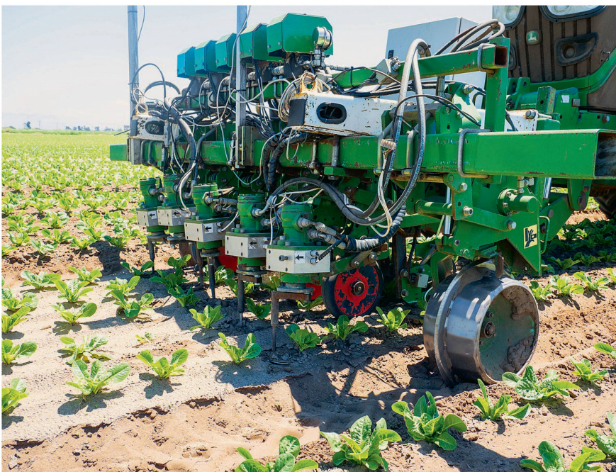
Les appareils de désherbage semi-autonomes sont déjà suffisamment développés pour maintenir l'interligne exempté d'adventices. Photo: ldd
