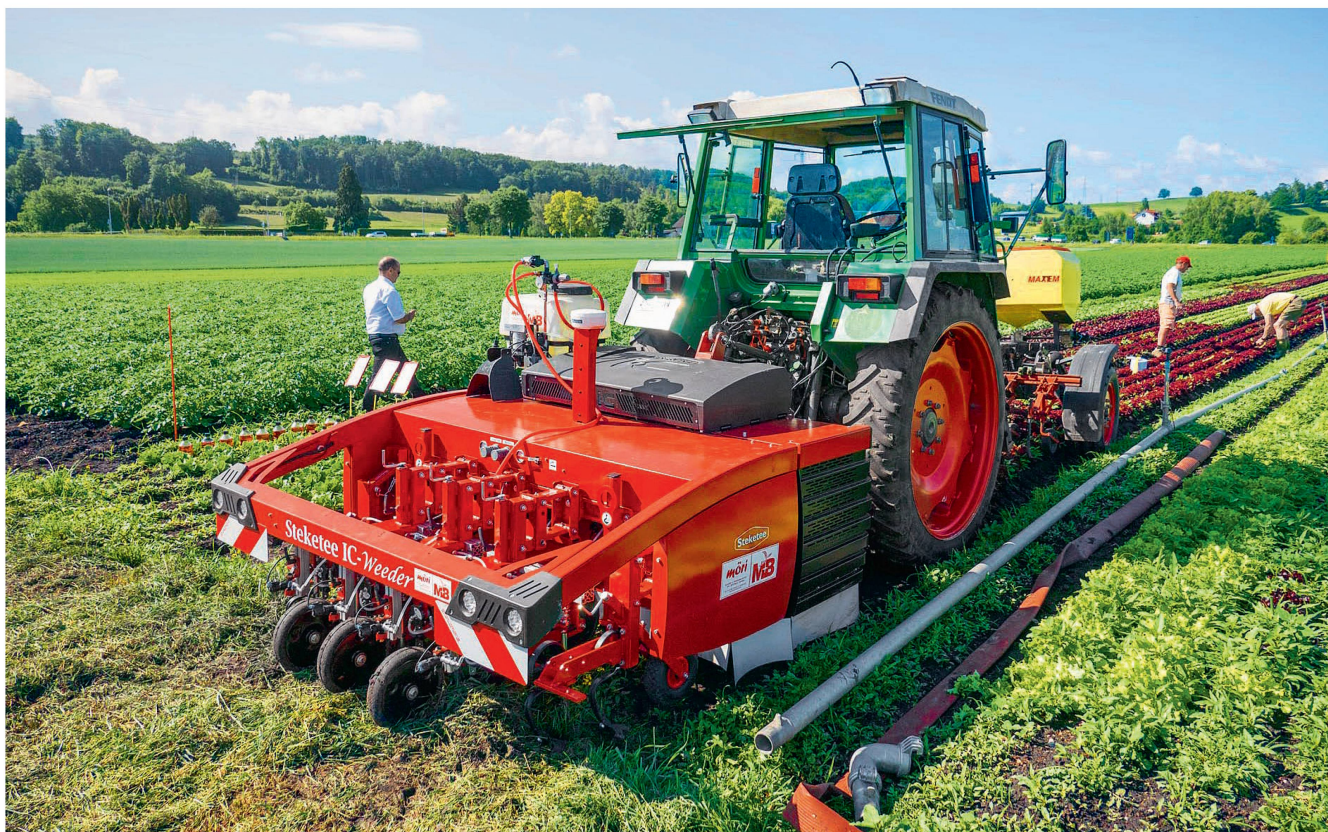
Les forces et les faiblesses du robot de binage ont été analysées durant trois ans dans le cadre d'un projet. Photo David Eppenberger
