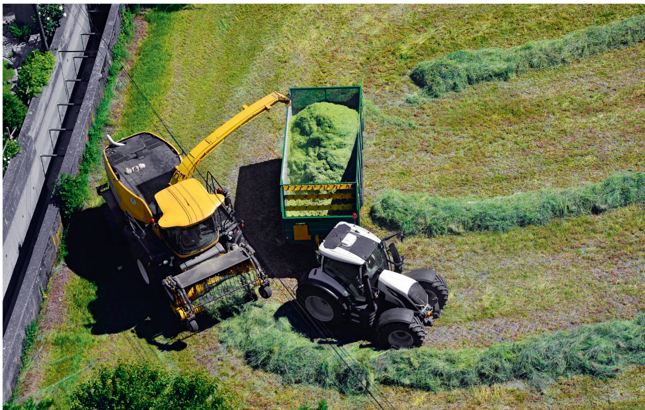
Détermination du rendement à l'aide de capteurs: la technologie NIR n'est que timidement utilisée sur les ensileuses. Photo: Ruedi Hunger
