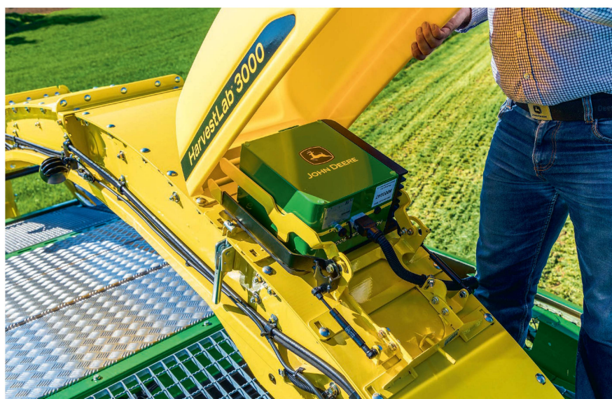
En fonction du capteur, il est possible de mesurer la teneur en matière sèche, mais aussi les composants de l'herbe, de la luzerne ou du maïs plante entière ensilés. Photo: JD
