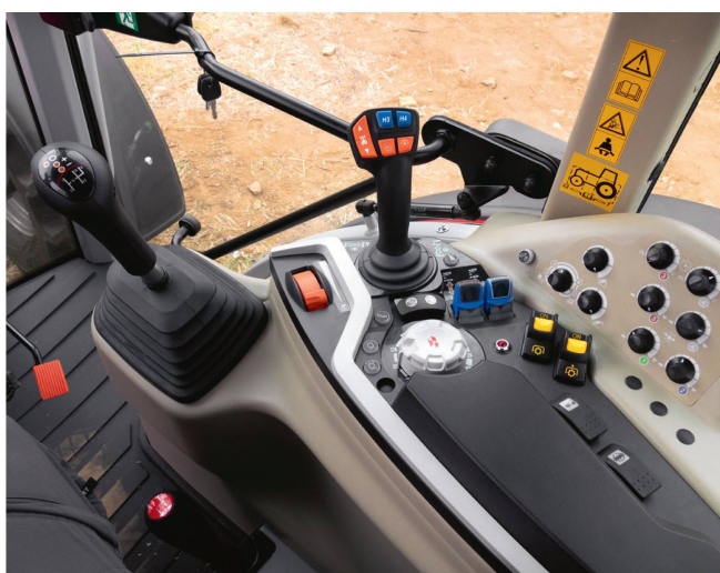
La finition «Efficient» comprend une transmission avec powershuttle et «Speedshift» de même qu'un joystick pour le contrôle de la transmission et de l'hydraulique.
