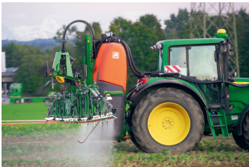
Il faut éviter de traiter par un vent supérieur à 12 km/h; si sa vitesse excède 19 km/h, il est interdit d'intervenir. Photo: Heinz Röthlisberger
