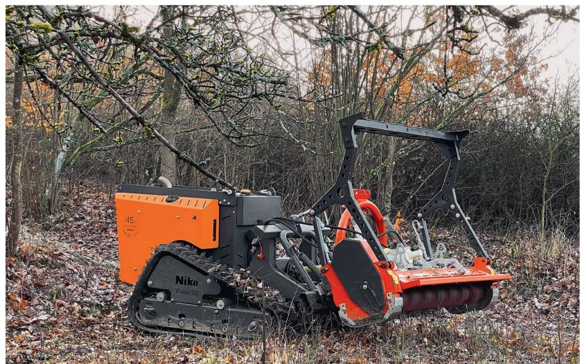
Avec le «RoboFlail Vario D501» Rapid élargit son catalogue de machines sur chenilles. Ce broyeur automoteur d'une puissance 50 ch se destine aux utilisations forestières et d'entretien du paysage. La transmission de puissance optimale à l'outil porté est assurée via un arbre à cardan, l'outil lui-même étant attelé à l'aide du relevage de catégorie 1. Pour augmenter la stabilité dans les pentes, le porte-outils est équipé d'un dispositif d'élargissement hydraulique du train de roulement de
