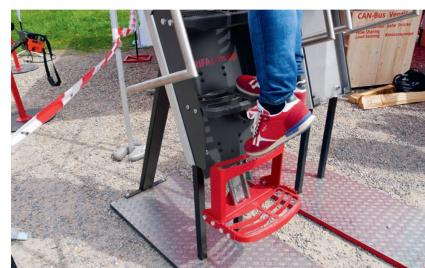
Griener Fahrzeugtechnik a développé le «SoftStep», un système d'assistance à la montée et à la descente pour tracteurs. Il s'agit d'une rallonge d'échelle fonctionnant comme un ascenseur. La dernière marche s'abaisse lentement lorsque l'opérateur quitte le véhicule.
