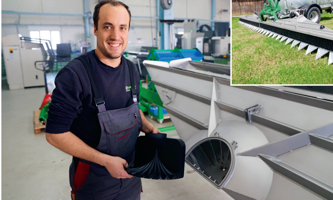
Thomas Hollenstein devant le «Schleppfix», le répartiteur de lisier à faible usure, sans tête de distribution et sans pendillards. L'épandage du lisier est exclusivement assuré par l'action de la gravité (petite photo). Photos: Dominik Senn et Roman Engeler
