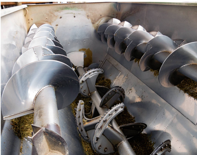
La cuve de mélange en acier inoxydable massif de la «Superchamp SL» a une contenance de 14 mètres cubes. Trois arbres à pales horizontaux assurent le brassage nécessaire.
