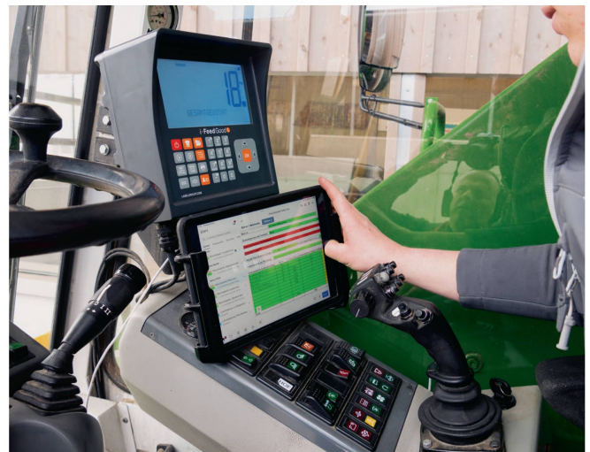
Le conducteur a accès aux informations nécessaires pour chacun des élevages desservis sur sa tablette. Le terminal situé au-dessus pilote toutes les fonctions de la machine.
