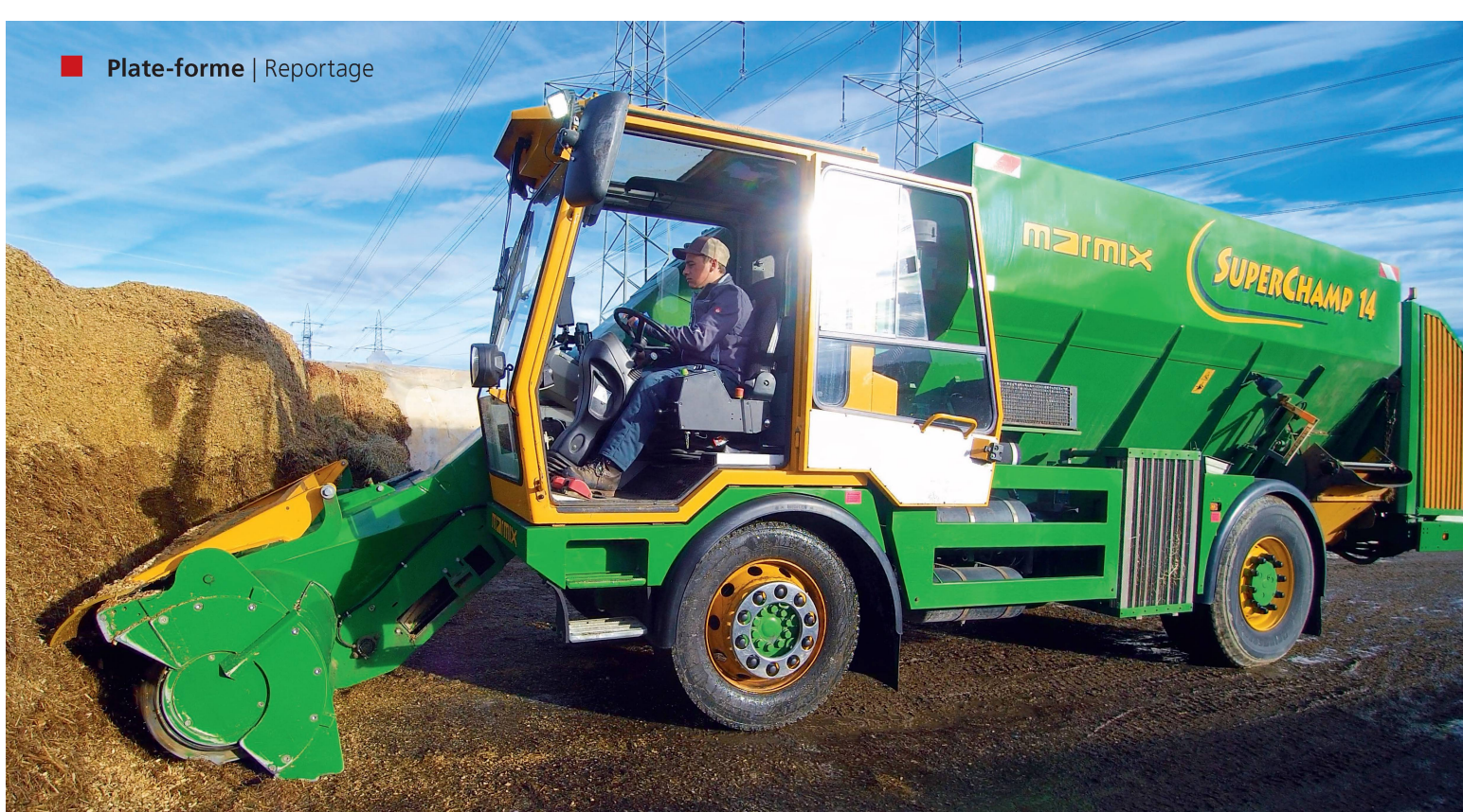
Le préparateur de rations remplit ici sa mélangeuse automotrice Marmix «Superchamp» de foin à partir d'un silo couloir. Photos: Roman Engeler
