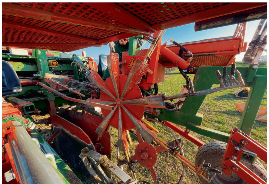
La roue de plantation est dotée de doigts préhenseurs maintenant la barbe et son tuteur en position jusqu'à leur libération à leur emplacement final en position verticale.
