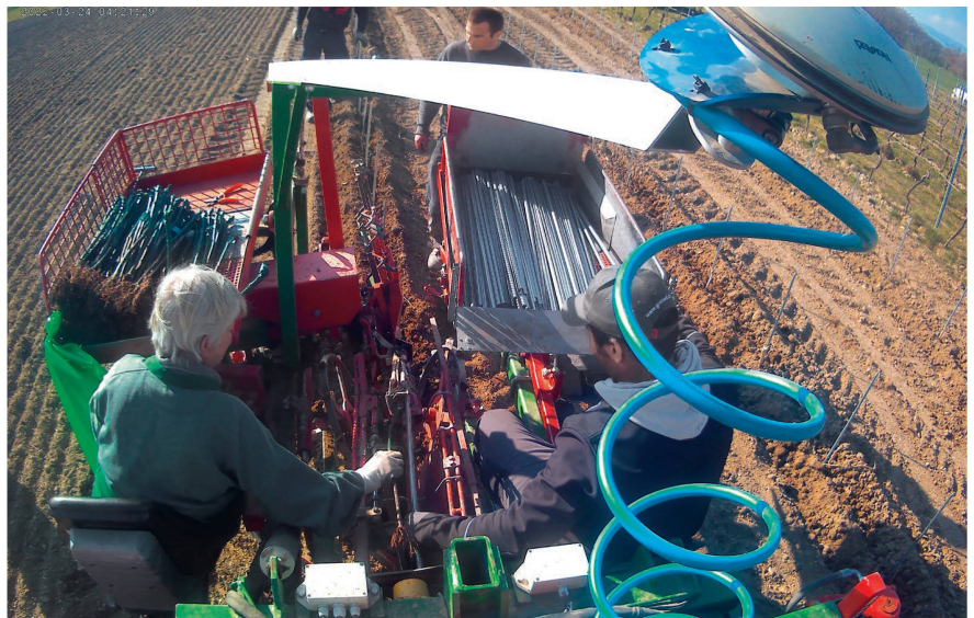
Deux opérateurs assis sur la planteuse placent horizontalement un à un les barbes et les tuteurs sur la roue de plantation. Au premier plan, l'antenne GPS.
