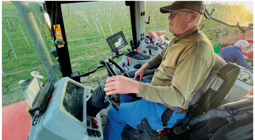
Le chauffeur Daniel Aguet ajuste en permanence sa trajectoire selon les indications d'une barre de guidage positionnée au-dessus du tableau de bord.
