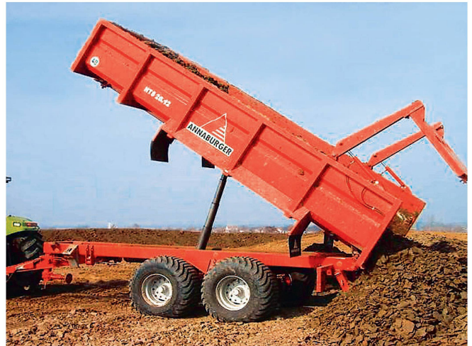
Si les marchandises se bloquent lors du déchargement, la calotte est poussée vers le haut.
