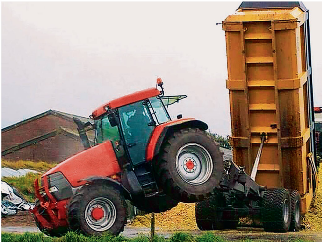
Le conducteur et l'attelage peuvent être mis en danger, notamment lors du basculement, si la charge d'appui est négative.
