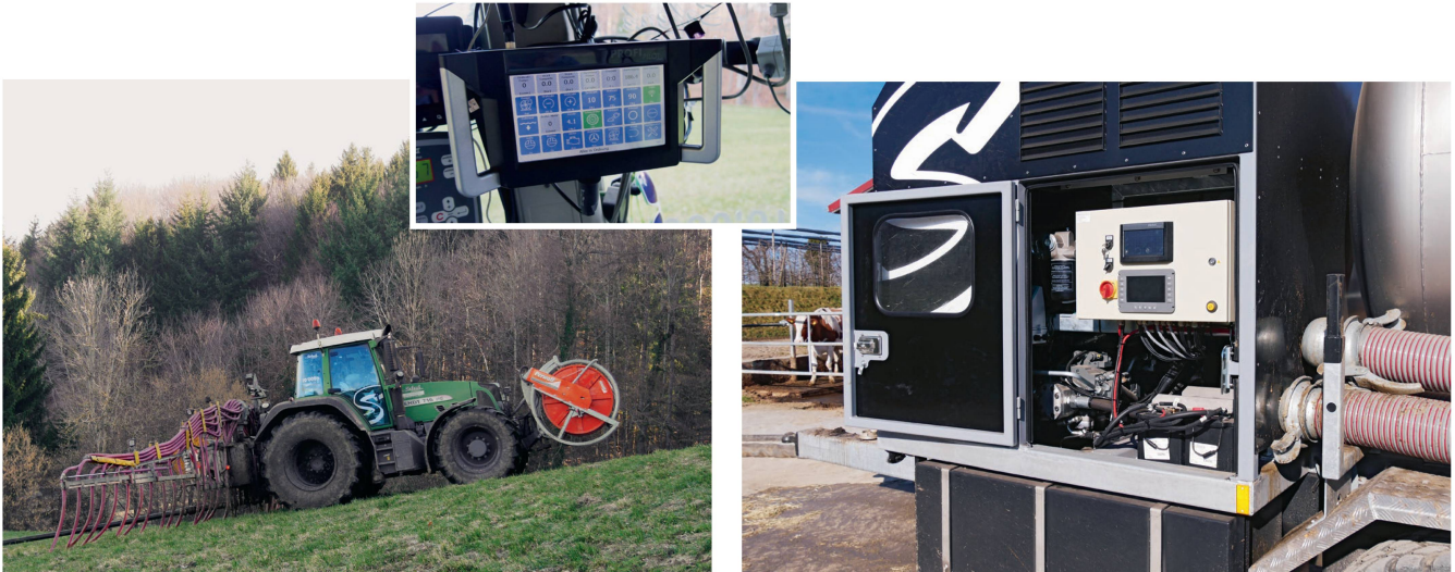
Grâce à la télécommande radio «ProfiPilot», le chauffeur peut commander et surveiller la pompe à distance et consulter par exemple le débit, le dosage de l'engrais et les données du moteur. L'unité de commande de la pompe est représentée à droite.
