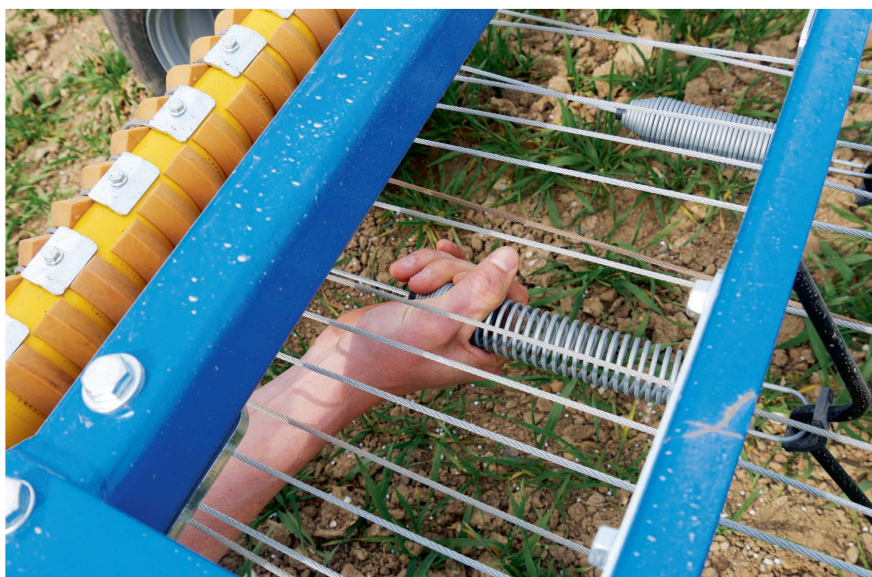
Les ressorts à forte tension assurent une pression homogène sur les dents. Un système de «ressort dans le ressort» est une option intéressante pour les cultures précoces.
