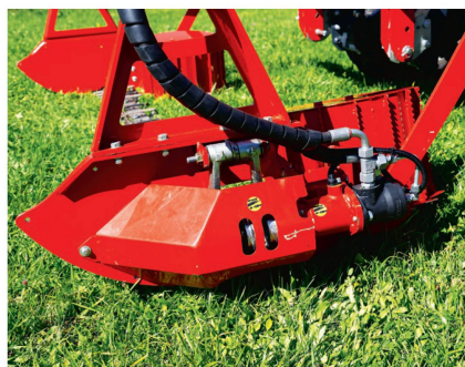
Les composants hydrauliques et les réducteurs sont adaptés au régime de prise de force du tracteur selon les souhaits du client.
