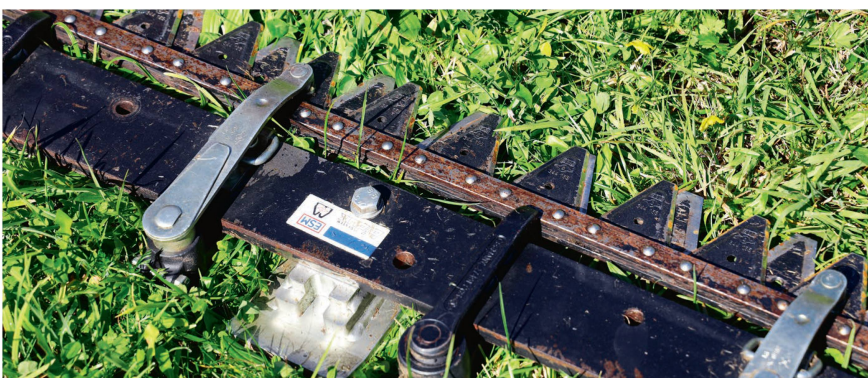
Le dispositif de coupe Bidux avec répartition inégale des couteaux provient de la société ESM.
