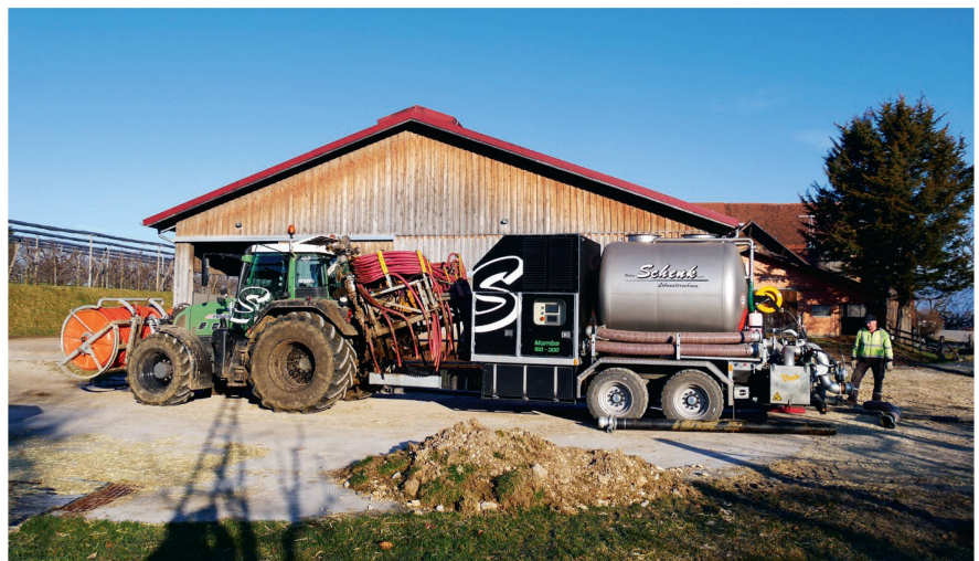
Le long timon de la remorque de la pompe permet de déplacer l'ensemble de l'attelage d'un endroit à l'autre en laissant le pendillard attelé à l'arrière du tracteur.
