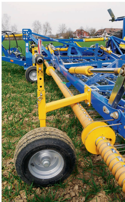
La pression sur les dents est réglée hydrauliquement et de manière centralisée de 100 à 5000 grammes sur les 31 cm de course des ressorts. Ces derniers sont mis en tension au moyen du rouleau jaune (photo de gauche).
