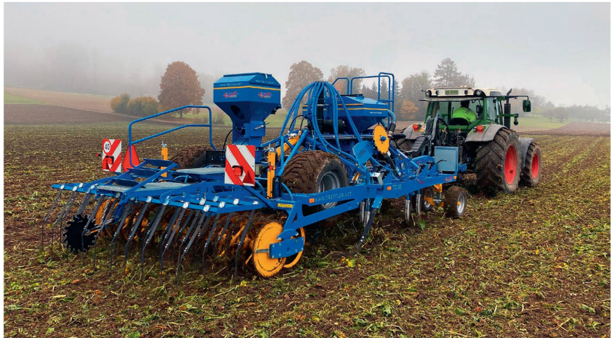
Le déchaumeur de précision «TG 300» sème ici du blé d'automne qui succède à une culture de betteraves sucrières. Photo: Idd
