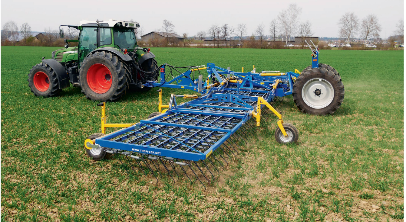
La herse étrille de précision Treffler «TS 1220 M3» au travail à Seuzach (ZH). Le châssis de la herse de 12,2 mètres de large est attelé aux bras de relevage inférieurs. Photos: Heinz Röthlisberger
