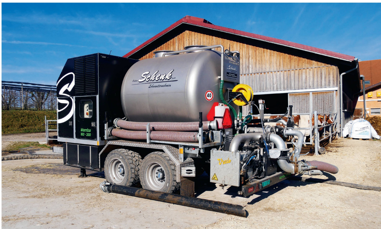
La pompe à lisier «Mamba 160-300» possède un moteur 6 cylindres de 312 chevaux (puissance maximale) et un réservoir de 5000 litres à deux compartiments pour l'engrais liquide et l'eau. Photos: Heinz Röthlisberger
