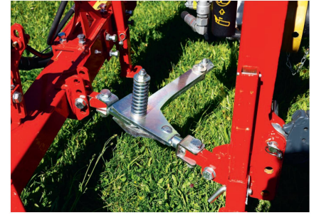
La faucheuse arrière est pourvue d'une sécurité anticollision mécanique.
