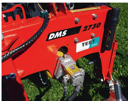
Les composants hydrauliques et les réducteurs sont adaptés au régime de prise de force du tracteur selon les souhaits du client.
