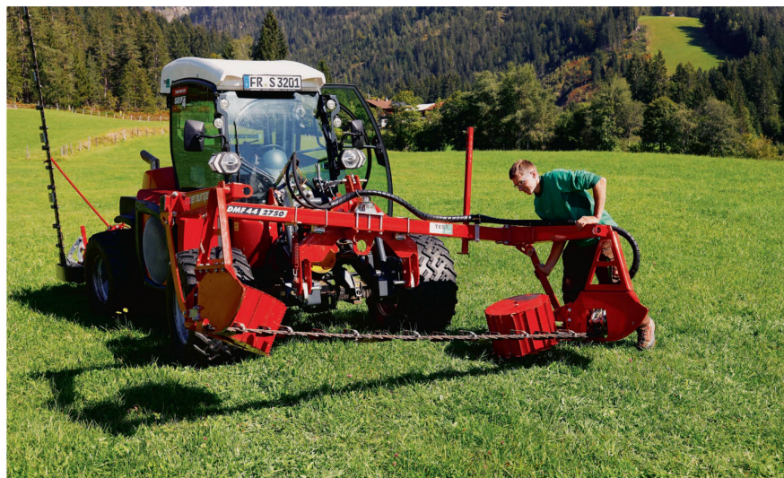
La faucheuse frontale est fixée par une articulation à rotule qui offre une course importante.
