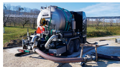
La pompe à vis est équipée d'un régime variable en continu et développe jusqu'à 16 bars.
