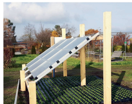
Cette installation expérimentale de l'Université des sciences appliquées de Zurich (ZHAW) se situe à Wädenswil (ZH). La mâche pousse sous les modules photovoltaïques. Photo: ZHAW
