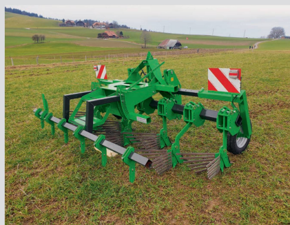
Exemples d'équipements pour les cultures sur buttes: buttoir et outils d'entretien pouvant être associés en option à un semoir pneumatique. Photos: Rohrbach Technik, Oberbütschel
