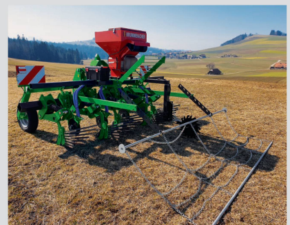
Exemples d'équipements pour les cultures sur buttes: buttoir et outils d'entretien pouvant être associés en option à un semoir pneumatique. Photos: Rohrbach Technik, Oberbütschel
