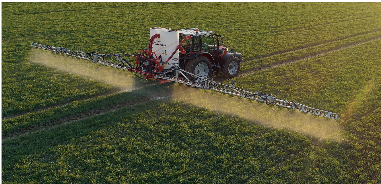
Le pulvérisateur Kuhn «Deltis 2» dispose d'une fonctionnalité de rinçage assisté utilisable depuis la cabine et compatible avec les exigences de l'Office fédéral de l'agriculture. Photo: Kuhn
