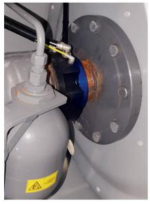
Le raccord tournant de l'installation de télégonflage PTG à deux conduites. Ici sur un MF «85». Photo: Mario Stettler
