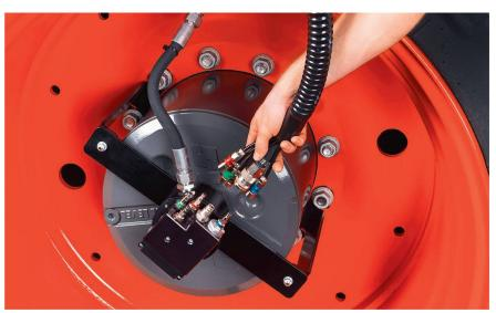
Les cinq conduites du télégonflage Claas «CTIC» peuvent être découplées et déposées sur le garde-boue du tracteur. Photo: Claas
