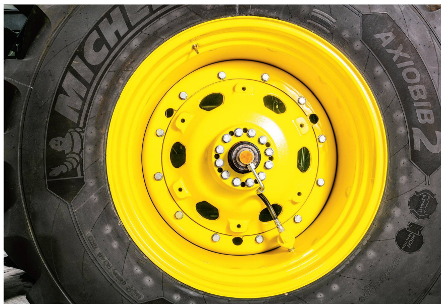
L'installation de télégonflage que John Deere installe sur sa gamme «8R» est à conduite simple. Photo: John Deere
