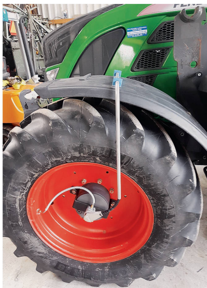
Sur l'installation de télégonflage à conduite simple Téléflow, le raccord tournant est associé avec la valve de roue. Photo: Agrosam
