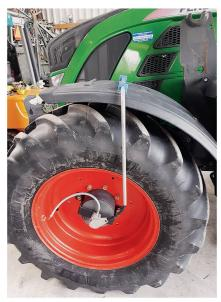
Sur l'installation de télégonflage à conduite simple Téléflow, le raccord tournant est associé avec la valve de roue. Photo: Agrosam
