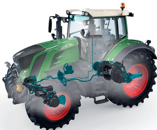
Fendt offre une installation de gonflage à deux conduites montée en usine sur ses tracteurs. Elle s'appelle «VarioGrip». Photo: Fendt
