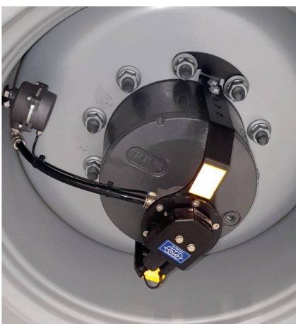
Des systèmes à raccords tournants extérieurs: en haut, un télégonflage à conduite simple, en bas un modèle à deux conduites sur une MF «8S» dont les flexibles ne sont pas accouplés. Photos: STG et Mario Stettler
