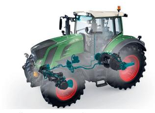
Fendt offre une installation de gonflage à deux conduites montée en usine sur ses tracteurs. Elle s'appelle «VarioGrip». Photo: Fendt
