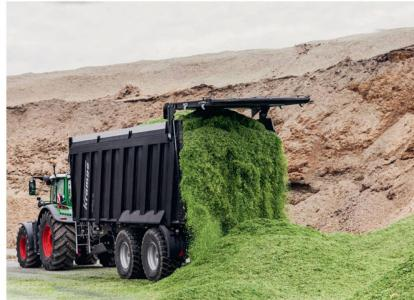
La première remorque à fond poussant, portant le nom de «**RamBody**» et la désignation «**AS 750**», sera dans un premier temps fabriquée en version tandem, avec une capacité de chargement de 41,1 m<sup>3</sup>. Outre les ressorts paraboliques de série ou le train roulant à compensation hydraulique, Krampe propose aussi une suspension pneumatique. Une caractéris-
