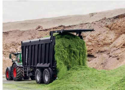
La première remorque à fond poussant, portant le nom de «**RamBody**» et la désignation «**AS 750**», sera dans un premier temps fabriquée en version tandem, avec une capacité de chargement de 41,1 m<sup>3</sup>. Outre les ressorts paraboliques de série ou le train roulant à compensation hydraulique, Krampe propose aussi une suspension pneumatique. Une caractéris-
