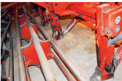
L'engrais est déposé derrière quatre socs ouvreurs puis enfoui juste avant l'implantation de la culture. Photo: Matthieu Schubnel
