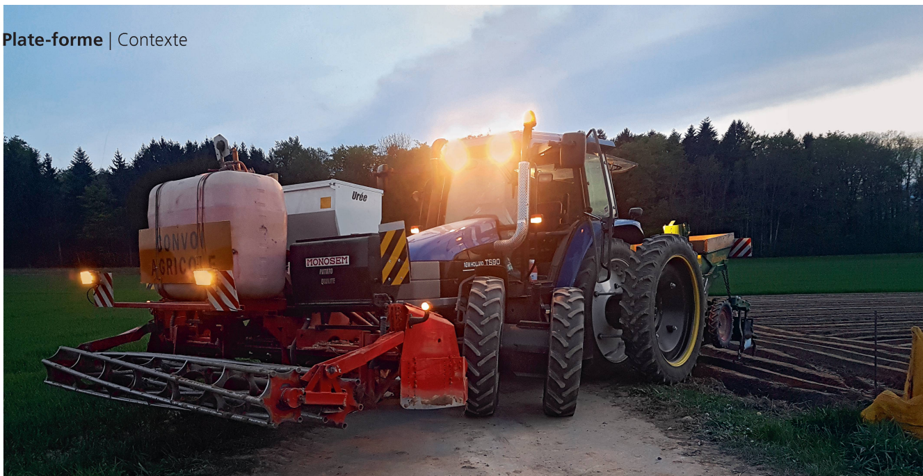
L'outil frontal «Patatop» imaginé par Madrick Bonny est capable d'assurer la fertilisation et le traitement au moment de l'implantation des cultures en rangs, afin de limiter le nombre de passages. Photo: Madrick Bonny / Francine Bastian
