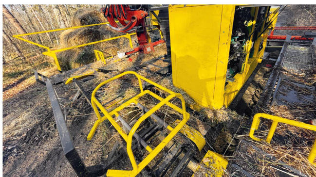
À l'arrière de la presse, un dispositif mécanique piloté depuis la cabine évacue les balles par translation vers les deux rampes de stockage situées sur les flancs de la machine pour former une première rangée.
