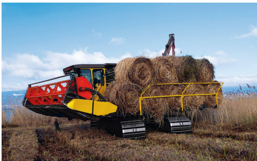
Compte tenu du sol peu porteur du marais, les changements de sens de marche en bout de parcelle sont opérés en quelques secondes, avec une rotation à 180° de la tourelle, minimisant ainsi les dégâts au sol lors des manœuvres.
