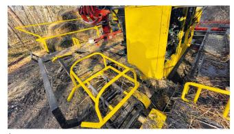
À l'arrière de la presse, un dispositif mécanique piloté depuis la cabine évacue les balles par translation vers les deux rampes de stockage situées sur les flancs de la machine pour former une première rangée.
