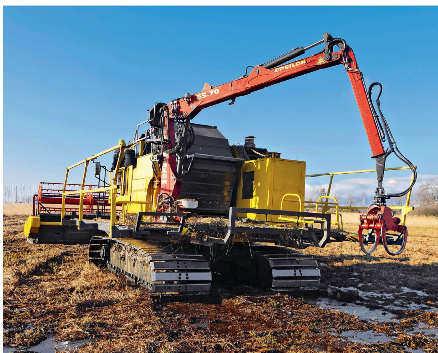
Pesant 19 t à vide, la machine est montée sur une base d'excavatrice comprenant deux larges chenilles de 110 cm chacune et une tourelle.
