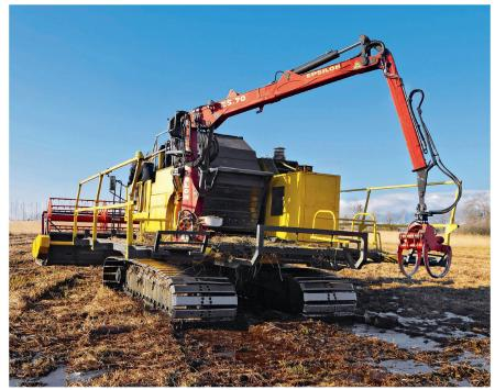
Pesant 19 t à vide, la machine est montée sur une base d'excavatrice comprenant deux larges chenilles de 110 cm chacune et une tourelle.
