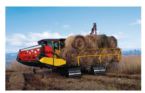
Compte tenu du sol peu portant du marais, les changements de sens de marche en bout de parcelle sont opérés en quelques secondes, avec une rotation à 180° de la tourelle, minimisant ainsi les dégâts au sol lors des manœuvres.
