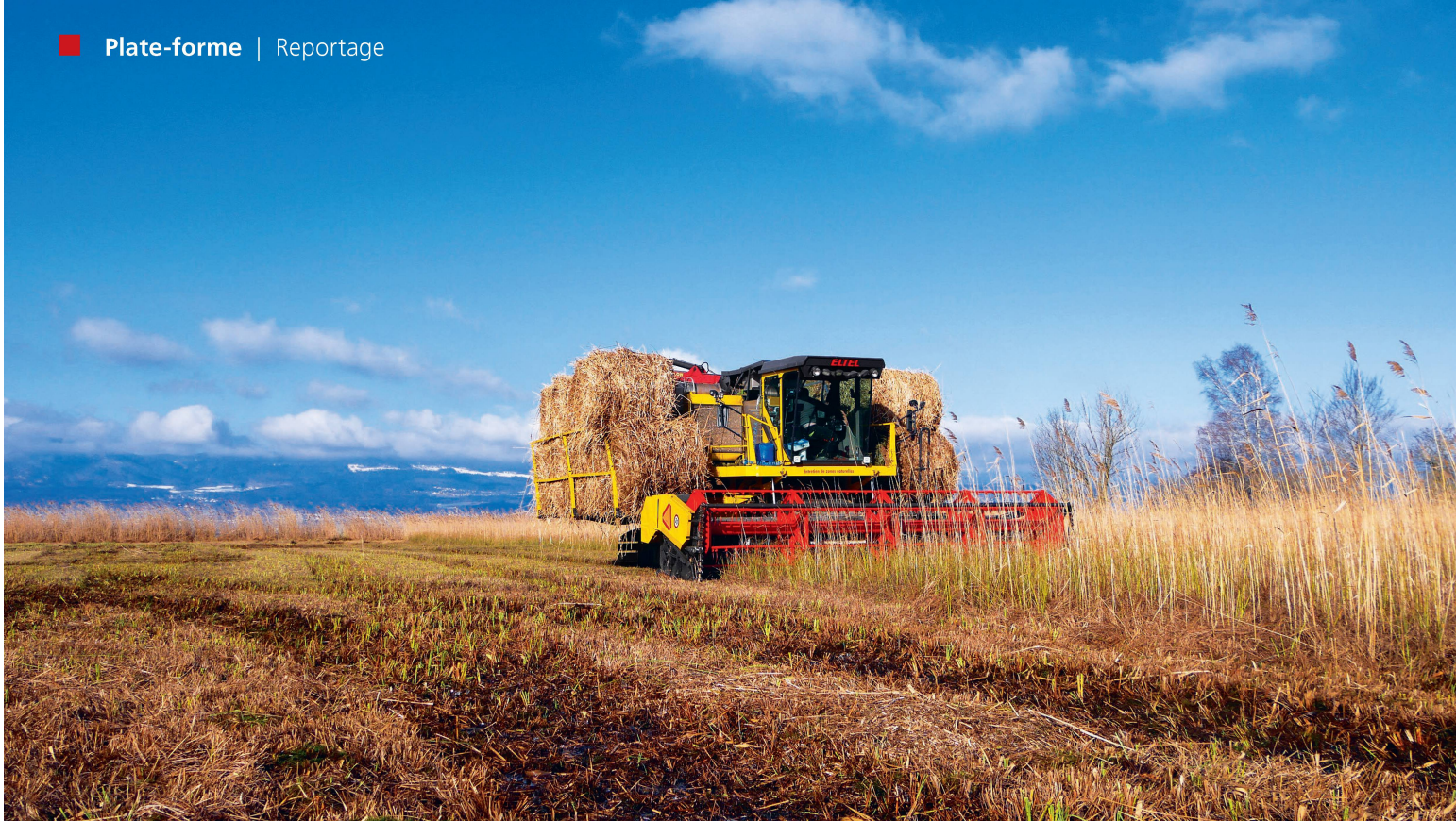
L'automotrice Elbotel de la société Eltel SA assure chaque année l'entretien de 50 à 60 ha de roselières sur la rive sud du lac de Neuchâtel, en combinant en un seul passage la fauche, le pressage, le ramassage et le transport des balles rondes de roseaux. Photos: Matthieu Schubnel
