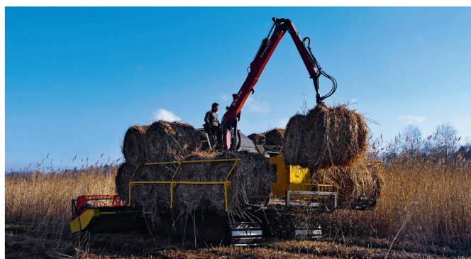
L'empilement à la grue d'une seconde rangée de balles interrompt temporairement le pressage, mais permet au chauffeur d'embarquer jusqu'à 22 balles rondes sur l'Elbotel.
