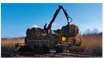
L'empilement à la grue d'une seconde rangée de balles interrompt temporairement le pressage, mais permet au chauffeur d'embarquer jusqu'à 22 balles rondes sur l'Elbotel.
