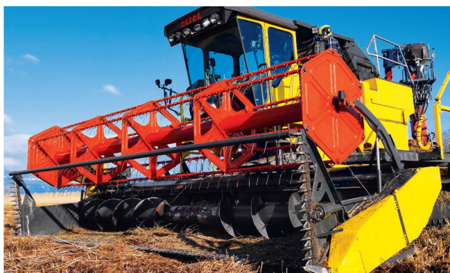
La coupe, similaire à celle d'une moissonneuse-batteuse classique, comprend un rabatteur et des rallonges de coupe latérales sectionnant les roseaux couchés par le vent.
