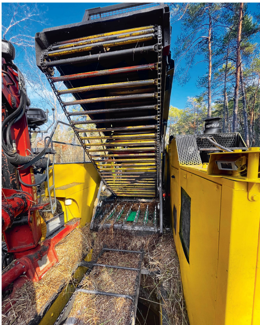
Installée juste derrière la cabine, la chambre de pressage (ici porte ouverte) est composée de chaînes et barrettes, une configuration qui, à la différence des courroies, est capable de résister aux fragments coupants de roseaux.
