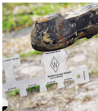
Le gabarit de contrôle Walterscheid pour calotte.
