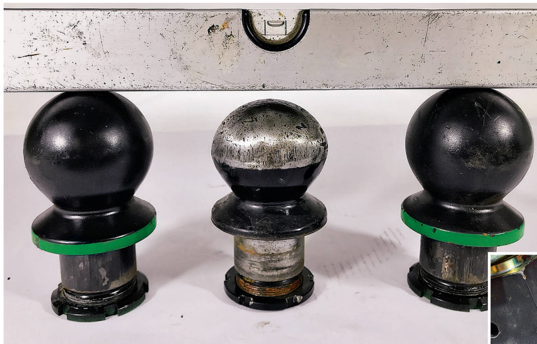
La boule du centre est un exemple parlant d'un élément fortement affecté par la «maladie des K80». Photos: Walterscheid
