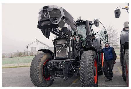
Le capot s'ouvre automatiquement par simple pression sur un bouton.
