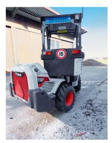
La position de l'articulation sous la cabine assure au chargeur une grande maniabilité et sa stabilité est maintenue.
