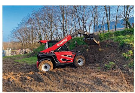
Avec sa transmission intégrale et sa garde au sol de 29 cm conséquente pour ce gabarit, l'ULM est prévu pour des utilisations tout terrain. Photo: Matthieu Schubnel
