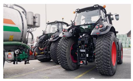
Les tracteurs de transport sont dépourvus de système hydraulique chez Agromesser, ce qui permet de limiter leur poids. Ils sont équipés de pneus de route Nokian.
