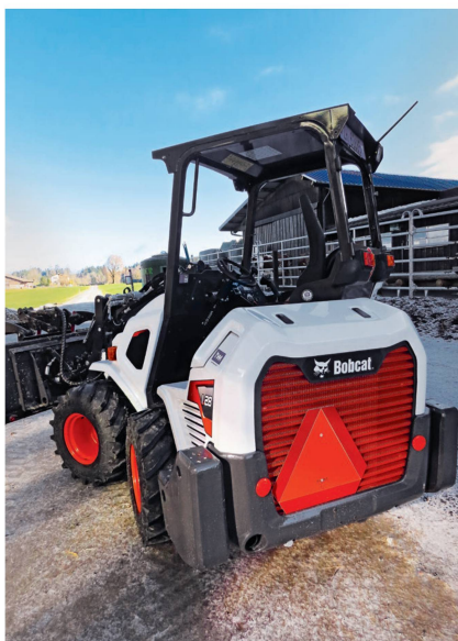
Munis de poids à l'arrière, le chargeur reste sûr, mais il tend à se cabrer en l'absence d'outil.
