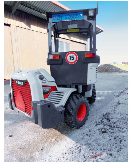
La position de l'articulation sous la cabine assure au chargeur une grande maniabilité et sa stabilité est maintenue.
