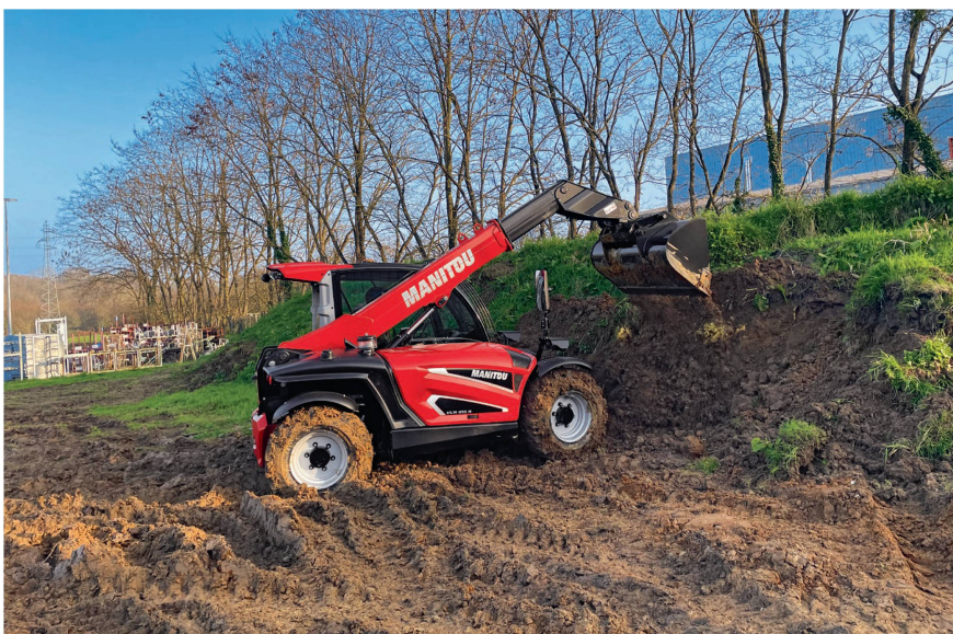
Avec sa transmission intégrale et sa garde au sol de 29 cm conséquente pour ce gabarit, l'ULM est prévu pour des utilisations tout terrain. Photo: Matthieu Schubnel
