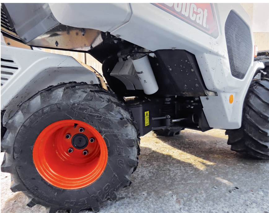
L'articulation massive ne possède pas d'amortissement pendulaire.
