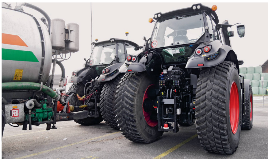
Les tracteurs de transport sont dépourvus de système hydraulique chez Agromesser, ce qui permet de limiter leur poids. Ils sont équipés de pneus de route Nokian.
