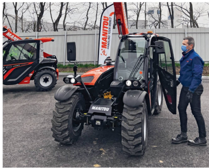
Avec une hauteur de 1,92 m et une largeur de 1,49 m, l'ULM impressionne par sa compacité. Photo: Matthieu Schubnel
