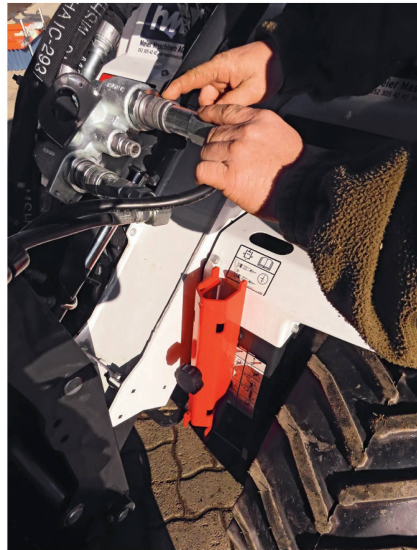
Les raccords hydrauliques plats avec décompression intégrée ont parfaitement fonctionné.
