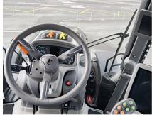
Accoudoir de commande «MaxCom»: les différentes fonctions telles que le contrôle de la vitesse d'avancement et l'inversion du sens de marche peuvent s'exécuter sans manipulation du joystick. Le Powershuttle est de série.
