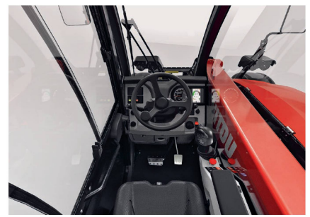
Dans la nouvelle cabine de 66 cm de largeur, l'opérateur retrouve la plupart des fonctionnalités disponibles sur les modèles de gabarit supérieur. Photo: Manitou
