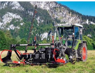
Faucheuse à double lame frontale avec une largeur de travail de 9 mètres.
