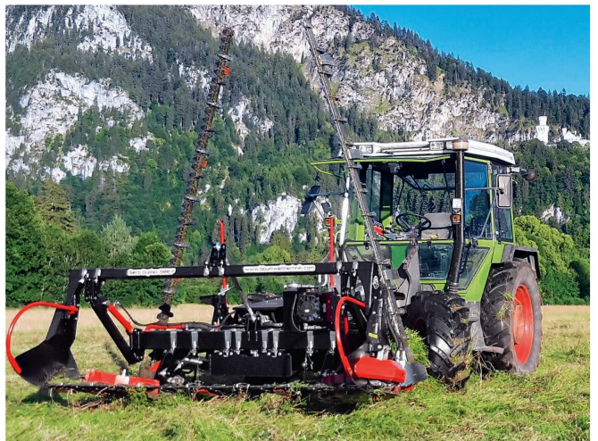
Faucheuse à double lame frontale avec une largeur de travail de 9 mètres.
