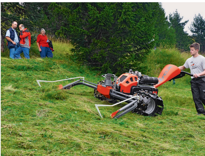
Il est possible de faucher en épargnant les insectes. Tous les constructeurs proposent les barres de coupe à double lame.
