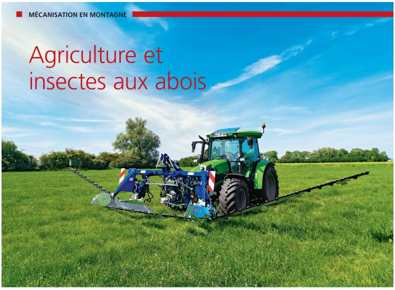
La faucheuse à double lame revient en grâce. Elle était considérée voici peu de temps encore comme une machine dépassée et peu performante. Photo: Idid
