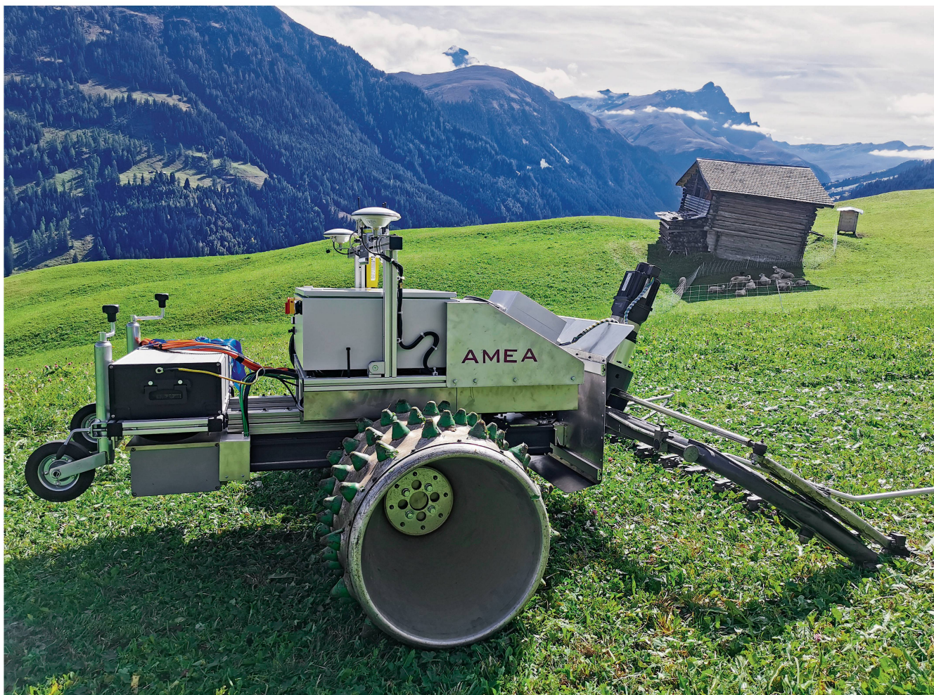
Le fauchage autonome dans les pentes et dévers n'est pas une mince affaire. L'«AMEA» est un monoaxe porte-outils qui évolue seul, mû par un entraînement entièrement électrique. Photos: Altatek GmbH
