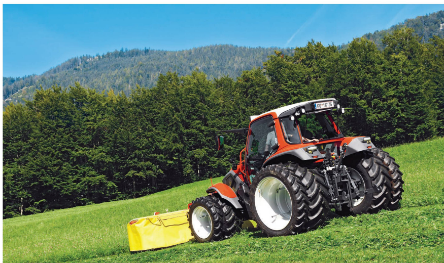
Le «Lintrac 100» convient parfaitement pour la mécanisation de l'agriculture de montagne grâce à son centre de gravité bas, son excellente agilité et sa technologie à variation continue. Photo: Ruedi Hunger
