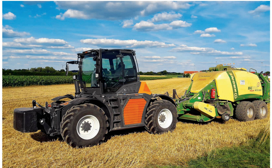
Non moins original et pensé jusqu'au moindre détail, le «Syn Trac» comporte deux interfaces de couplage identiques à l'avant et à l'arrière. Photo: Syn Trac
