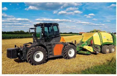
Non moins original et pensé jusque dans le moindre détail, le «Syn Trac» comporte deux interfaces de couplage identiques à l'avant et à l'arrière. Photo: Syn Trac
