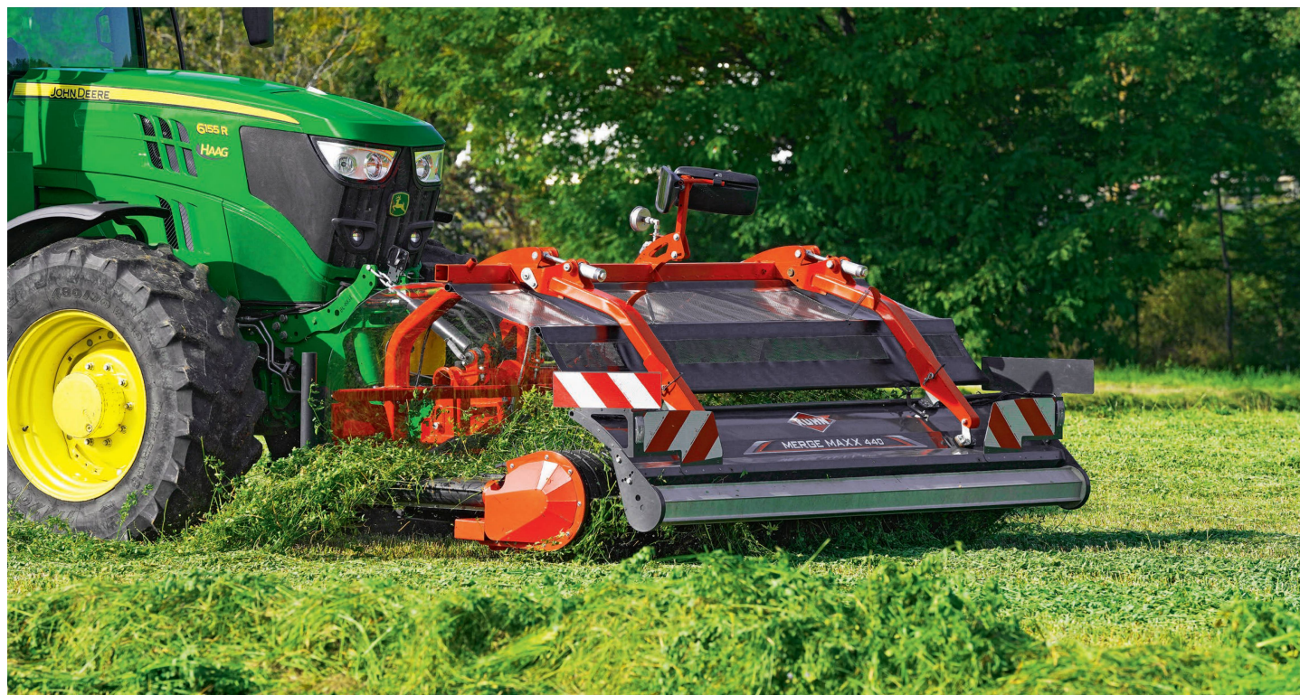
Avec le «Merge Maxx 440F», Kuhn propose désormais aussi un andaineur à tapis frontal. Photos: Kuhn
