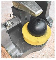
Boule «K80» avec bague en mousse pour la protection contre les souillures.
