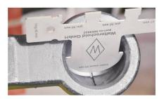
Gabarit de contrôle Walterscheid pour le contrôle des calottes.
