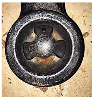
Deux exemples de calottes neuves avec rainures de lubrification en parfait état: photo de gauche, calotte Walterscheid, photo de droite, calotte Rockinger.
