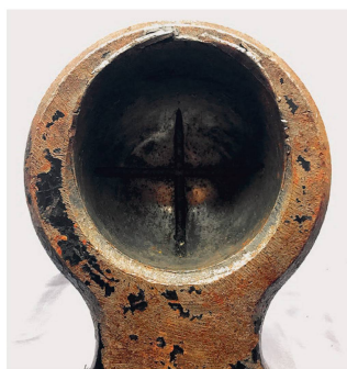
Des traces d'usure extrêmes (en haut) révèlent un mauvais réglage du levier de retenue.
