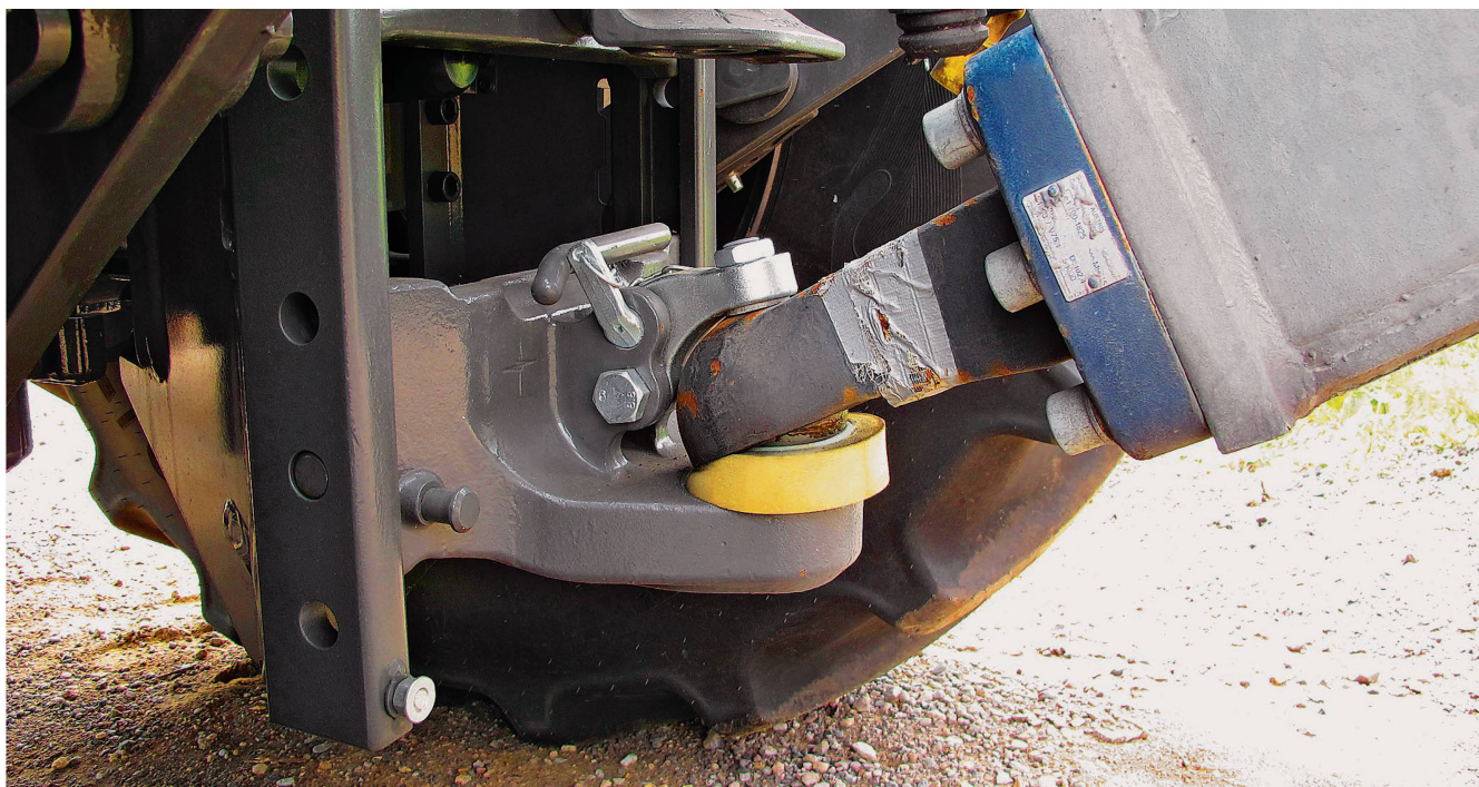
Exemple classique d'attelage par le bas avec un système à boule. Photos: Walterscheid
