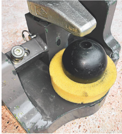
Boule «K80» avec bague en mousse pour la protection contre les souillures.
