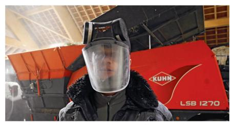
En cas de forte exposition à des poussières, des appareils filtrants à batterie recouvrant tout le visage assurent à l'utilisateur une bonne protection des yeux et des voies respiratoires, ainsi qu'un apport d'air frais. Photo: Heinz Röthlisberger
