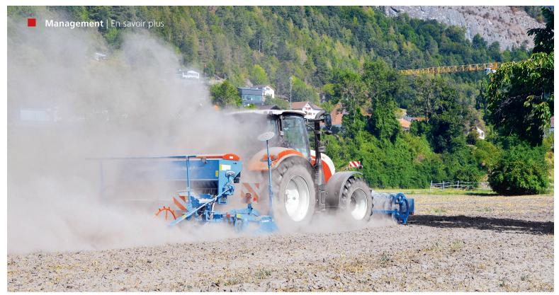
Des cabines fermées et des systèmes de filtration adaptés protègent le conducteur de l'exposition à la poussière. Photo: Ruedi Hunger
