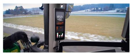
Le tableau de bord est remplacé par un afficheur intégré dans le montant droit de la cabine.
