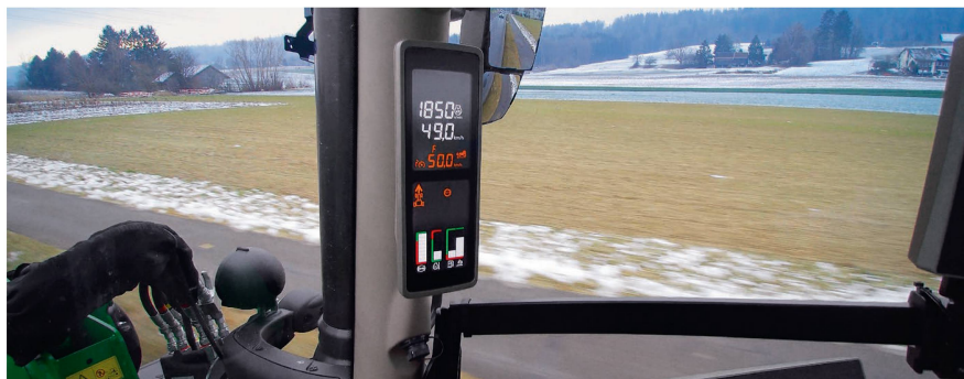
Le tableau de bord est remplacé par un afficheur intégré dans le montant droit de la cabine.
