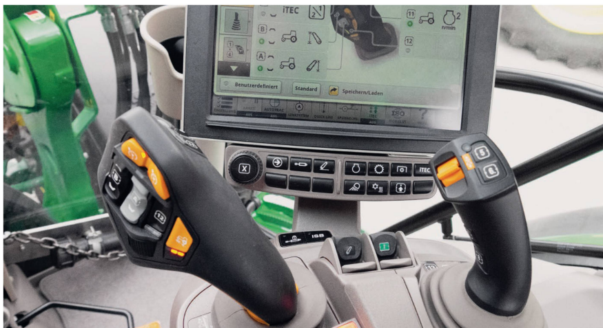
Vue du «centre de commandes»: le nouveau joystick électronique (à droite) sert désormais aussi à changer le sens de la marche.
