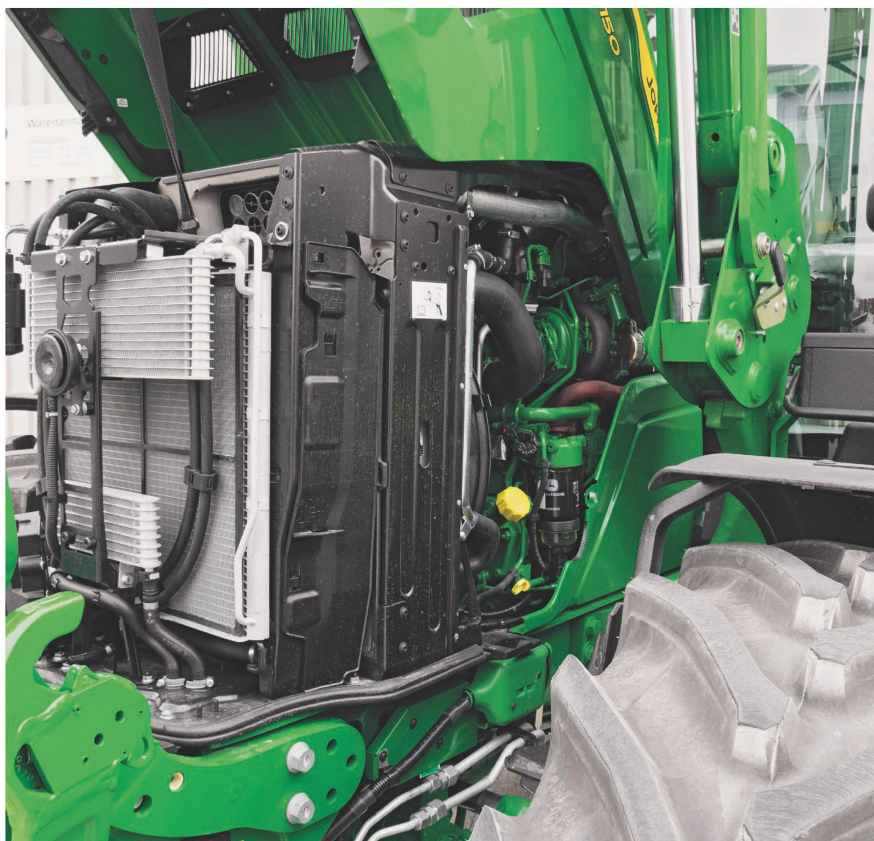
Le moteur du «6R 150» peut délivrer 12 chevaux de puissance supplémentaire, y compris pour les travaux demandant beaucoup de puissance hydraulique.
