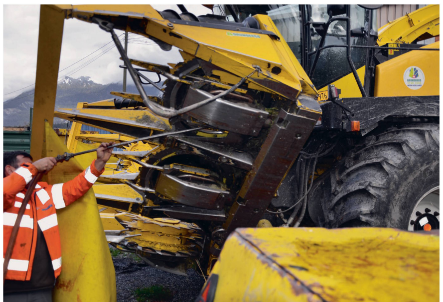
Lors du nettoyage des machines de récolte, il vaut la peine de procéder à un dégrassage grossier préalable avec un compresseur d'air performant. Photo: Ruedi Hunger
