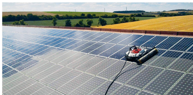
Les robots conquièrent le nettoyage des centrales solaires. Ils conviennent bien aux grandes installations. Photo: Serbot Gekko
