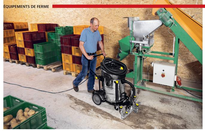
Aspirateur à embouts eau et poussières pour l'agriculture, avec cuve inox de 75 litres et puissance absorbée de 2760 watts. Photo: Idd
