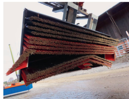
Les brosses rouges enlèvent les grosses saletés et les noires plutôt la poussière.
