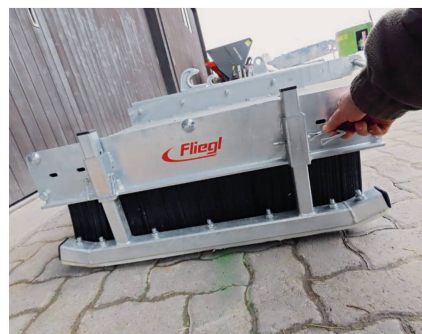
Le dispositif d'assistance sert à régler la pression du balai.
