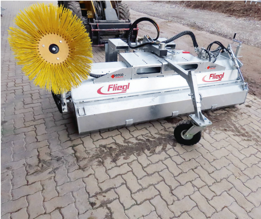
La Fliegl «Typ 600» est équipée de roulettes d'appui massives.
