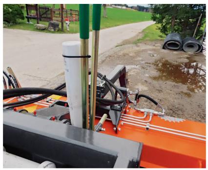
L'indicateur de positionnement est bien visible sur la machine.
