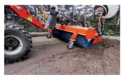
Les roulettes d'appui proches du rouleau garantissent un nettoyage soigné.
