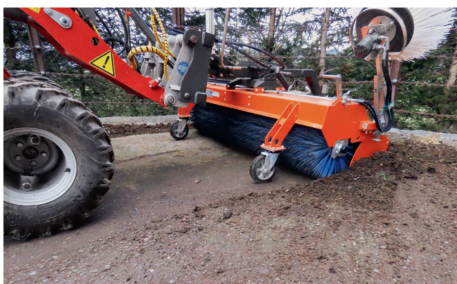
Les roulettes d'appui proches du rouleau garantissent un nettoyage soigné.
