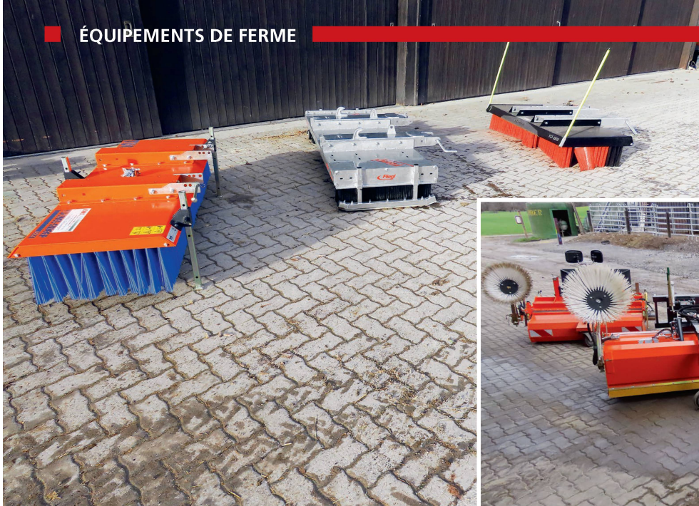
Les six équipements testés: à gauche les balais pousseurs et, ci-dessous, les balayeuses à entraînement hydraulique.
