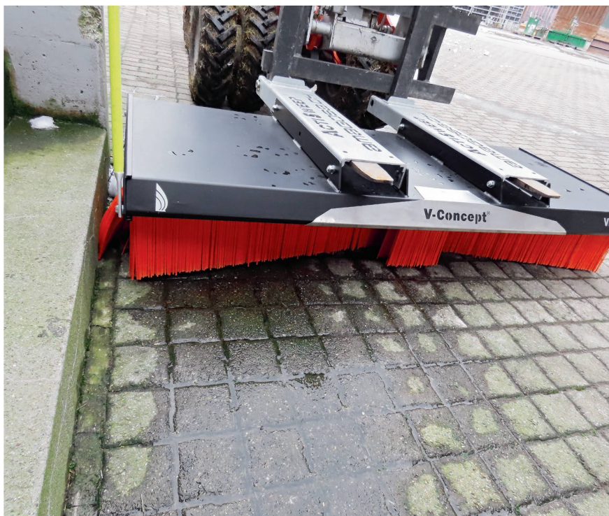
Les brosses en V à l'avant maintiennent la saleté devant la machine.
