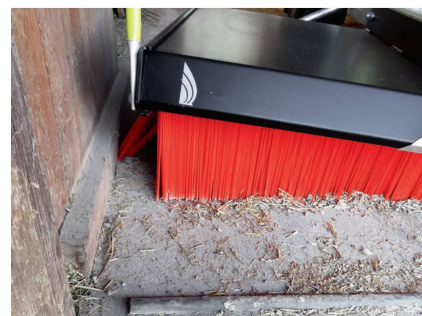
Le balayage d'une paroi est possible avec les brosses latérales.
