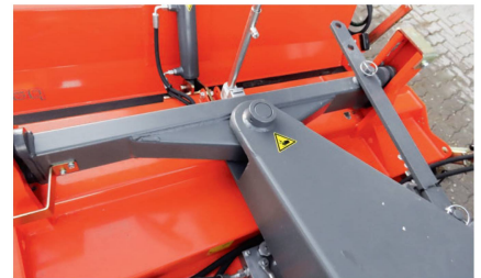
L'équilibrage 3D des roulettes permet l'adaptation au sol de tous côtés.
