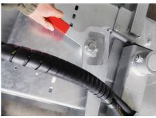
Un simple système de crantage permet de faire pivoter la machine de 30 degrés.
