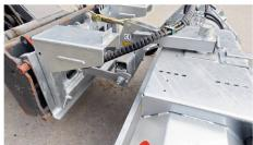
Grâce au parallélogramme avec bras supérieur télescopique, l'adaptation au sol est idéale.
