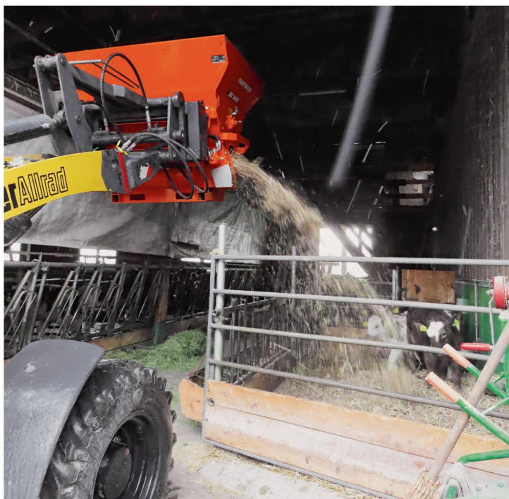
Même la paille de 20 cm directement extraite de la botte est éjectée à bonne distance.
