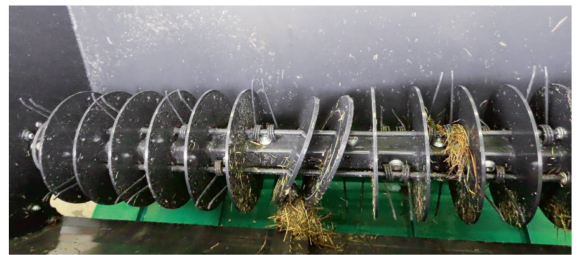
Le rouleau doseur est muni de dents à ressort sécurisées.
