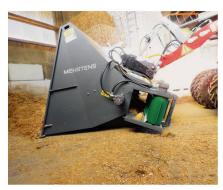
Les arêtes d'appui sont un peu faibles et mériteraient un surcroît de matière.
