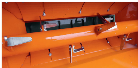
Le rouleau doseur à rotation réversible est équipé de 7 paires de doigts.
