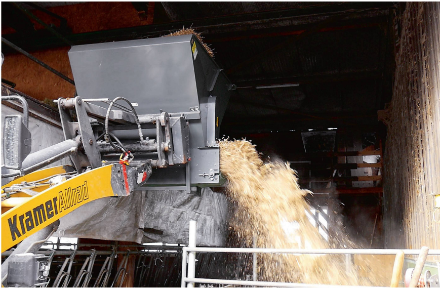
Avec sa contenance de 1,85 m 3 , ce godet est le plus grand de notre essai.
