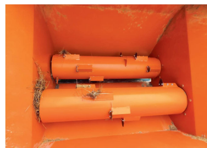
Les deux rouleaux doseurs sont munis au total de 22 couteaux.
