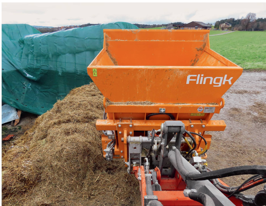
Le godet de petite taille laisse une bonne visibilité vers l'avant.
