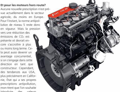
Le moteur «F28 Natural Gas», conçu pour les machines agricoles, est le premier de sa catégorie qui peut fonctionner avec des carburants alternatifs comme le biogaz. Photo: FPT
