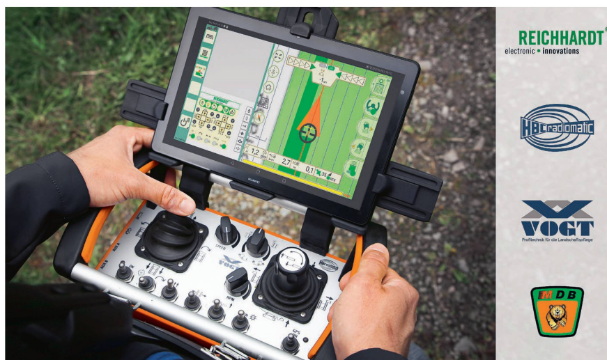
Ces télécommandes intelligentes sont conçues pour assister des processus de travail partiellement automatisés. Photo: Reinhardt
