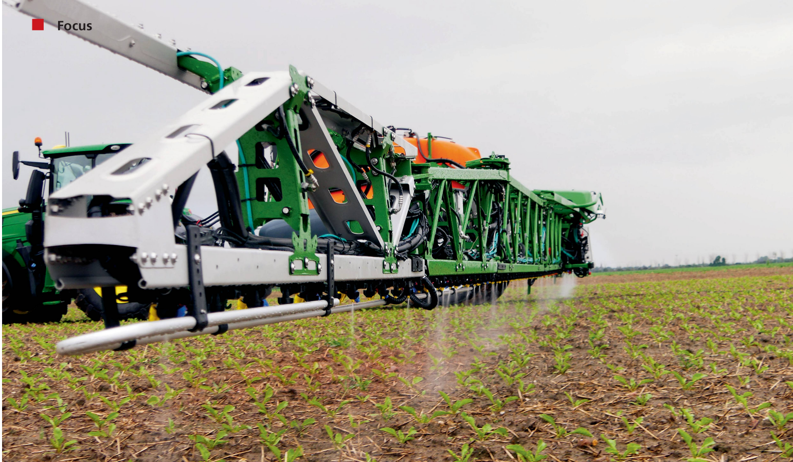
Pulvérisateur de pointe avec système de caméras et intelligence artificielle capable de faire la distinction entre les plantes cultivées et les adventices. Photo: Matthieu Schubnel
