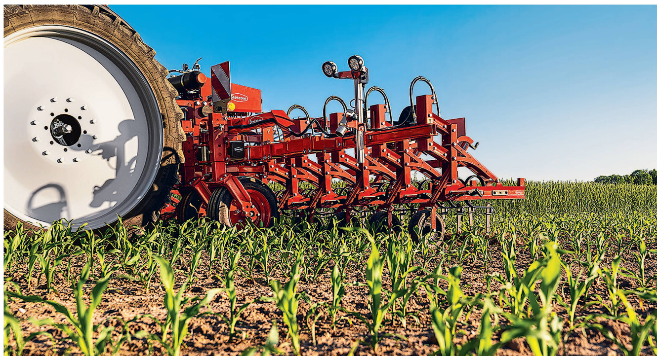
Les sarcleuses sont de nos jours munies de toutes sortes de capteurs qui améliorent leur précision et leur efficacité. Photo: Lemken/Steketee
