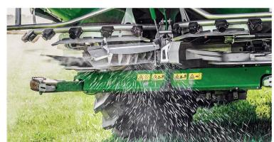
La fertilisation en bord de champ pour les grandes largeurs d'épandage est plus précise avec le déflecteur «BorderTS» d'Amazone pour distributeur d'engrais porté «ZA-TS» et traîné «ZG-TS». À la différence des dispositifs conventionnels, le «BorderTS» intègre le logiciel de l'appareil. Le nouveau déflecteur est combiné au système d'épandage de bordure «AutoTS».
